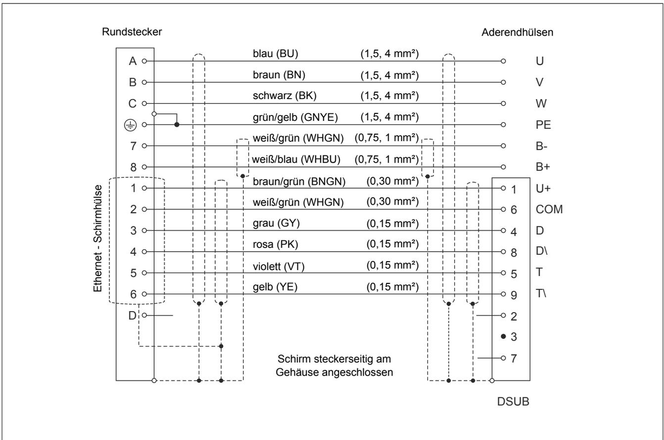
Abbildung 1: Kabelplan Motorhybridkabel
