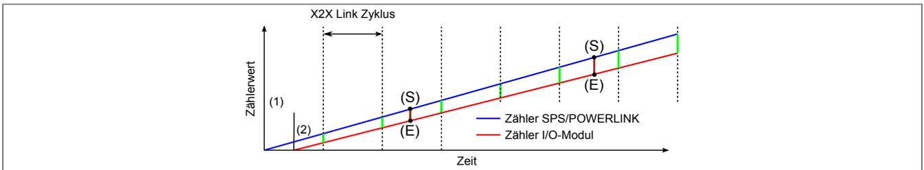
Beim Hochfahren starten die internen Zähler für die SPS/POWERLINK (1) und dem I/O-Modul (2) zu unterschiedlichen Zeiten und erhöhen die Werte im µs-Takt.
