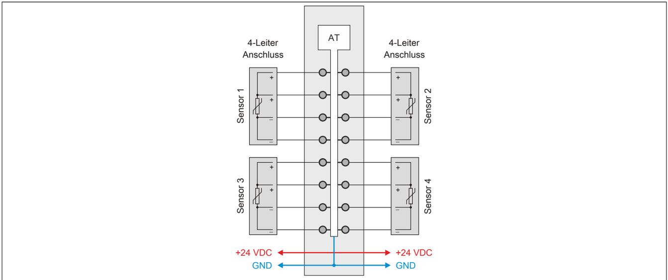
Um die Genauigkeit garantieren zu können, müssen links und rechts von diesem Modul Module mit einer Verlustleistung < 1,2 W gesteckt werden.
