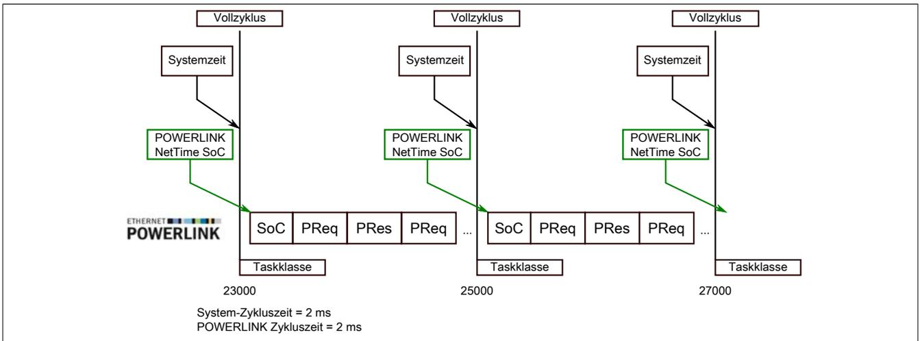
Der Referenzzeitpunkt am POWERLINK wird grundsätzlich beim SoC (Start of Cycle) des POWERLINK-Netzwerks gebildet. Der SoC startet systembedingt 20 µs nach dem Systemtakt. Dadurch ergibt sich folgende Differenz zwischen Systemzeit und POWERLINK-Referenzzeit:
