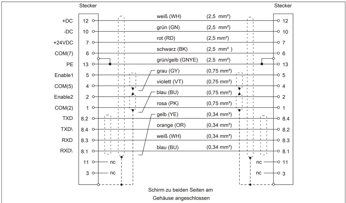
Abbildung 1: Kabelplan Hybridkabel
