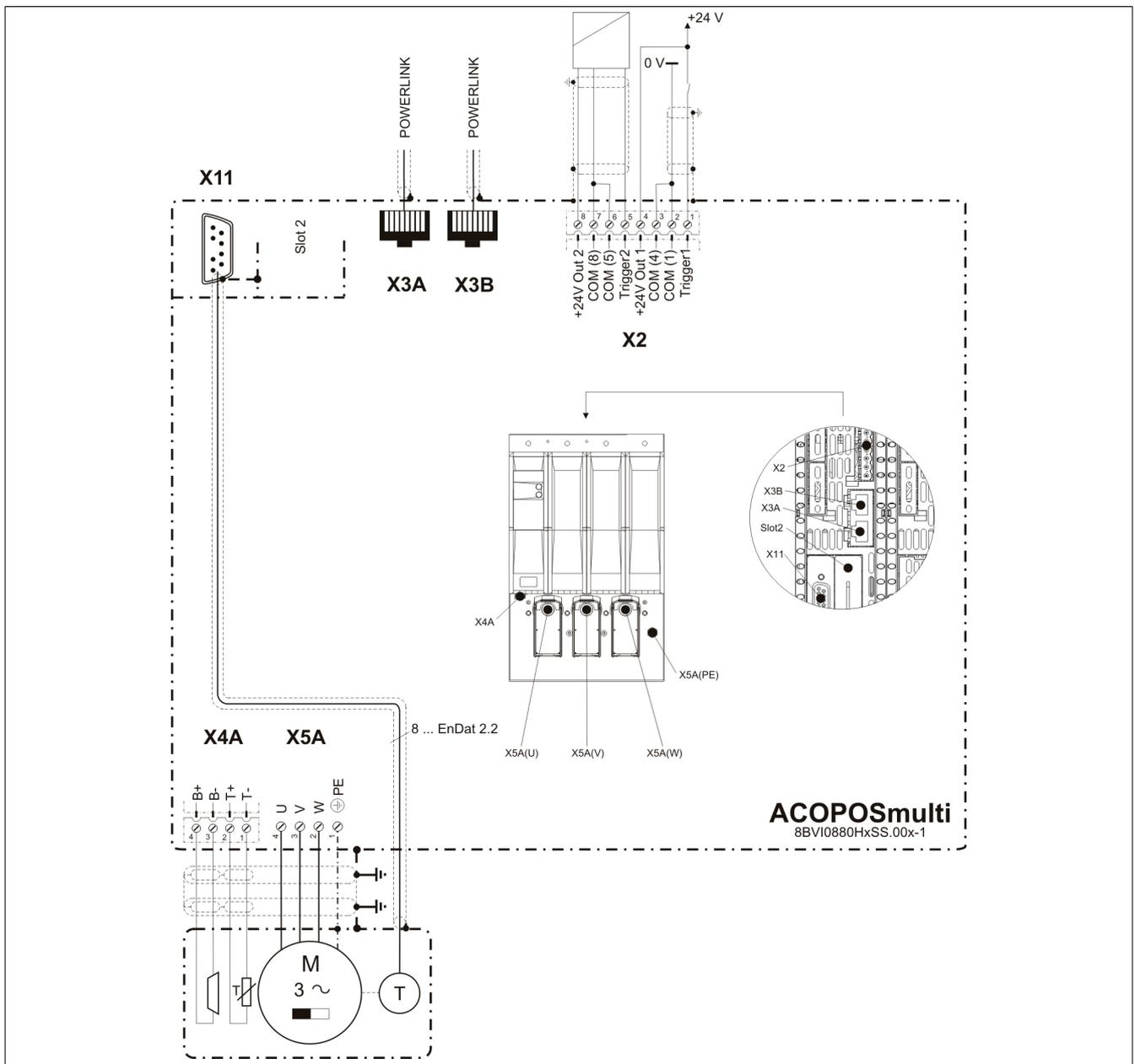
Abbildung 3: Übersicht Anschlussbelegungen
