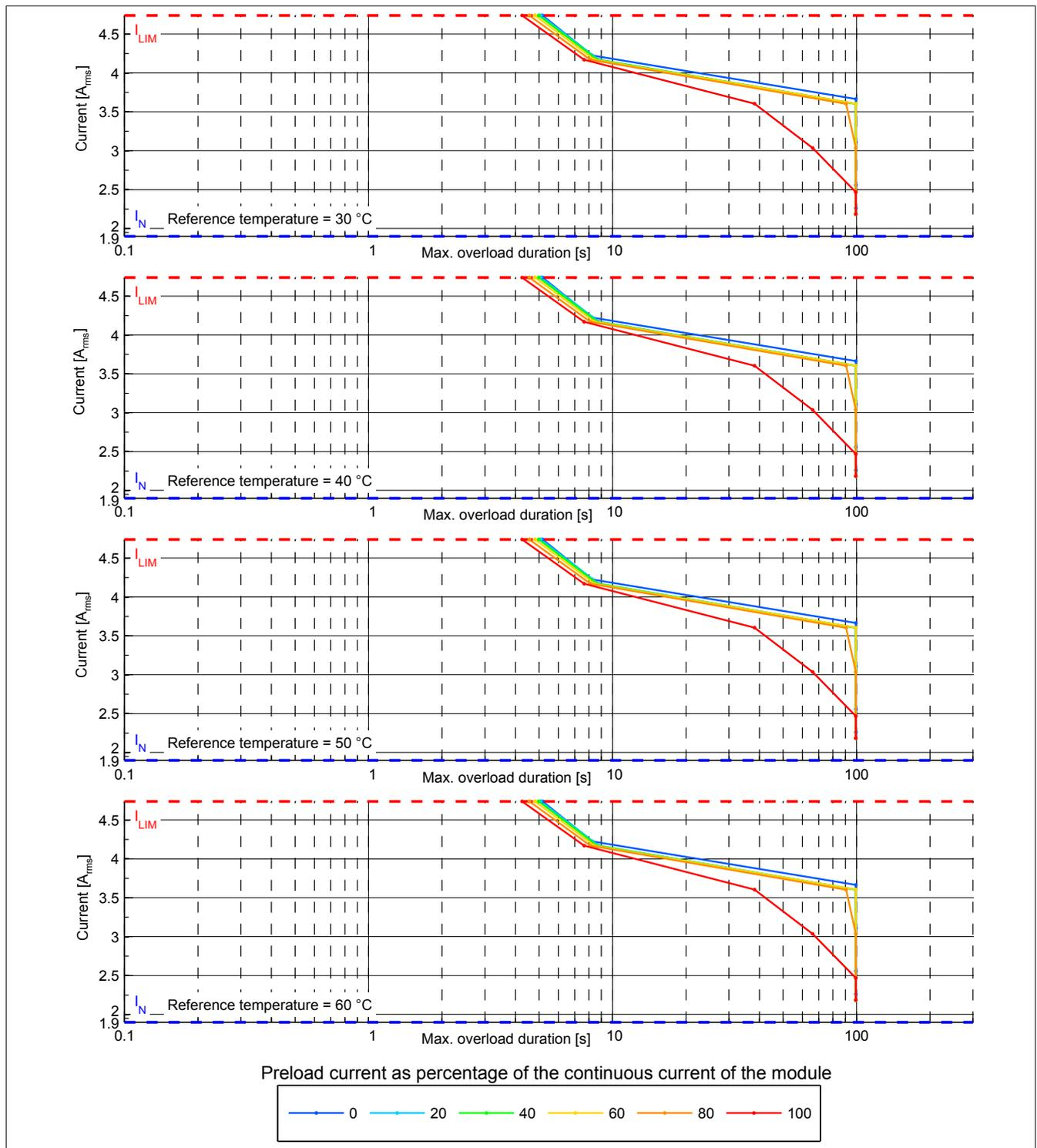
Abbildung 2: Überlast-Charakteristik 8BVI0014HCDx.000-x, Überlastreaktion - ERROR + STOP
