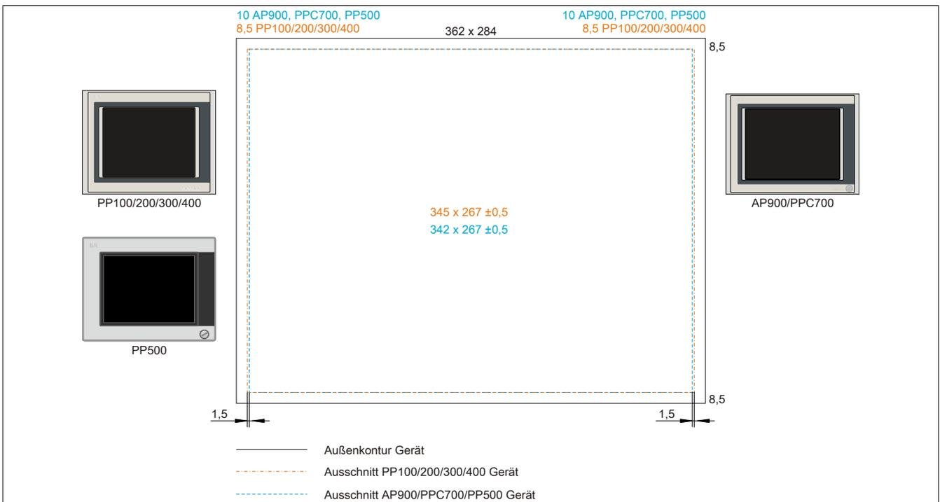
Abbildung 220: Einbaukompatibilität 12,1" Geräte Format Quer1
