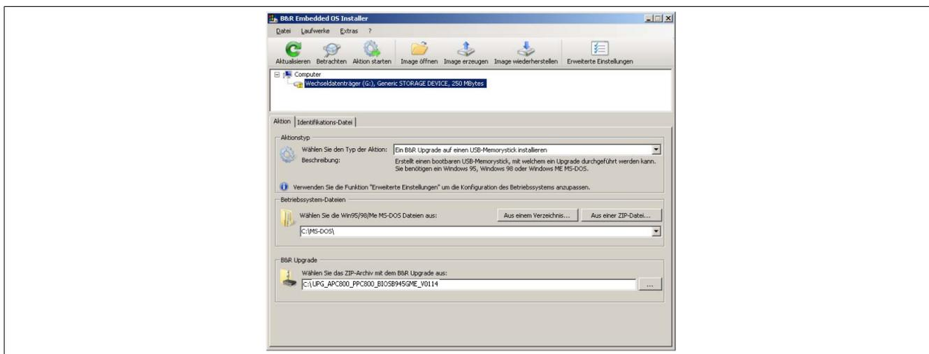
Abbildung 119: Erstellung eines USB Memory Sticks für B&R Upgrade Files
