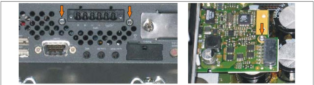
Abbildung 196: USV Modul montieren
