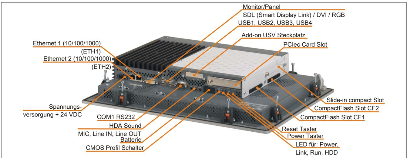
Abbildung 17: 5PC820.1906-00 - Rückansicht
