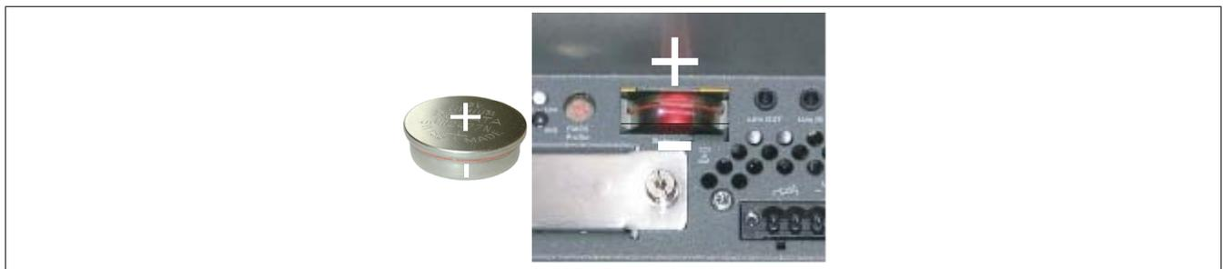
Abbildung 182: Batteriepolarität
