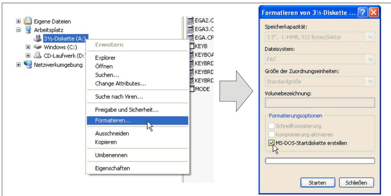
Abbildung 114: Bootdiskette erstellen unter Windows XP Schritt 1
