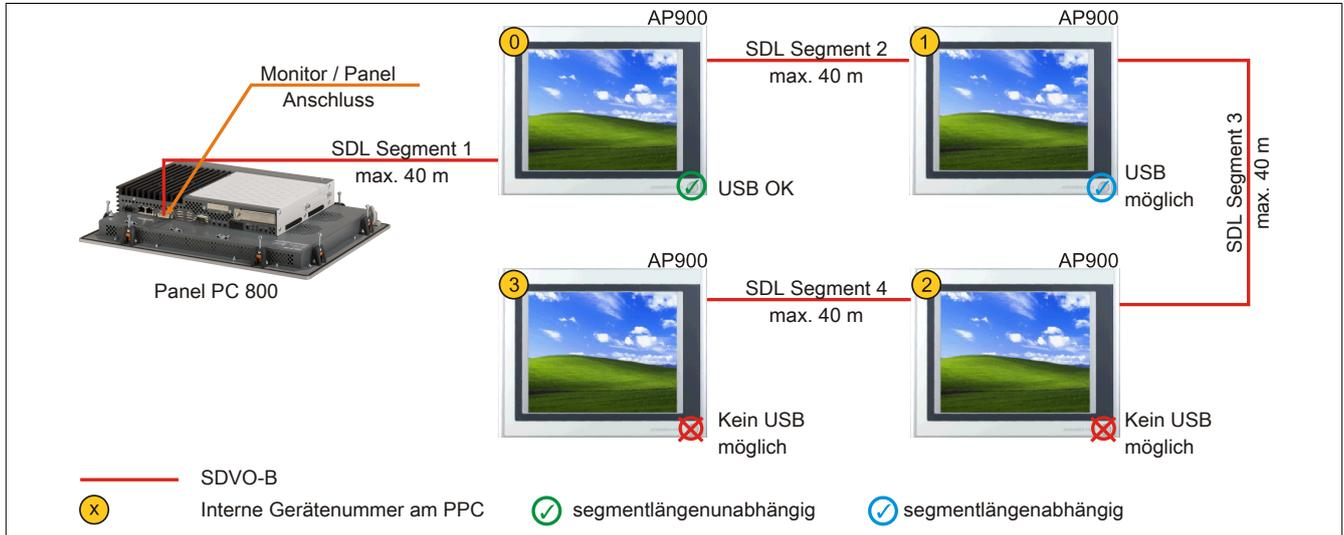
Abbildung 67: Vier Automation Panel 900 über SDL onboard
