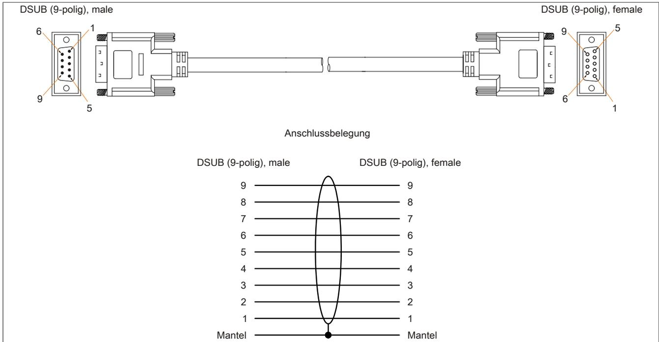
Abbildung 179: 9A0014.xx - Belegung RS232 Kabel
