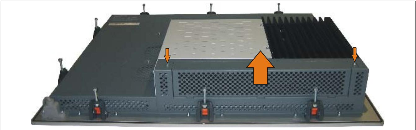
Abbildung 191: Lüfter Kit Abdeckung entfernen
