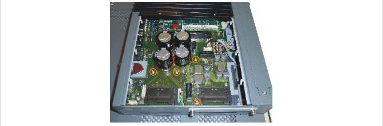
Abbildung 201: Schrauben lösen
