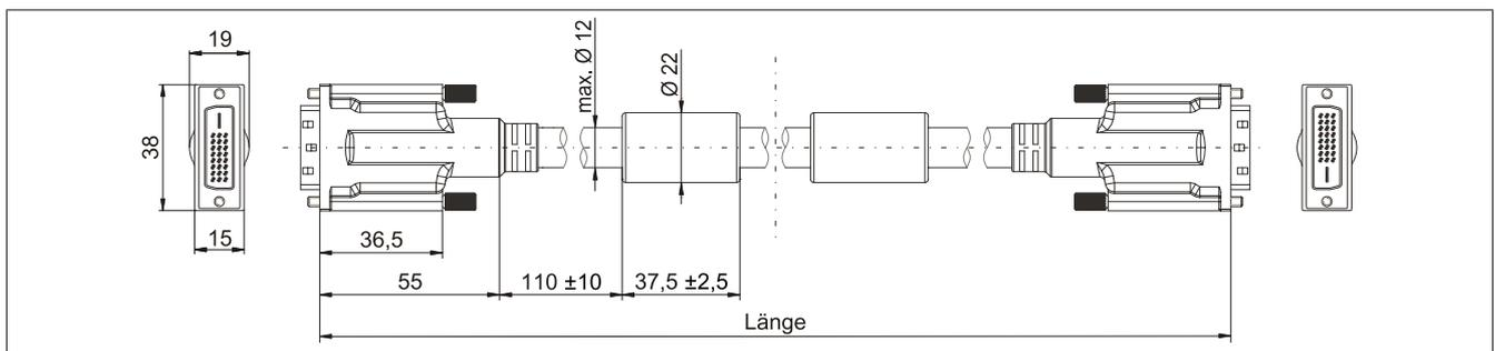
Abbildung 172: 5CASDL.0xxx-03 - Abmessungen
