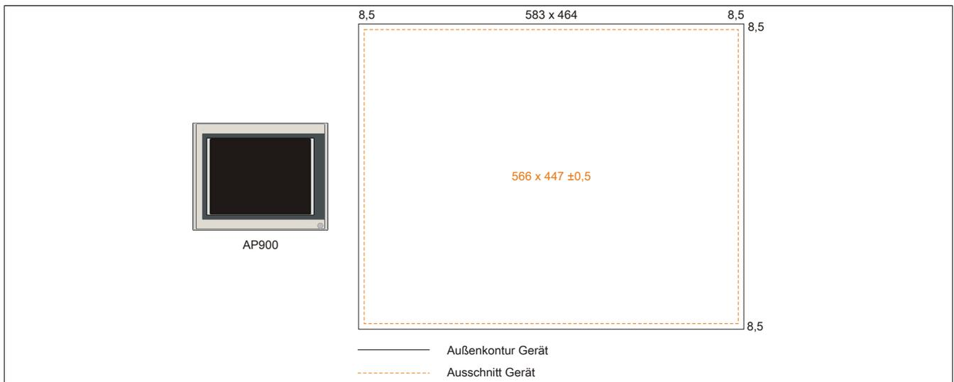
Abbildung 225: Einbaukompatibilität 21,1" Geräte Quer1
