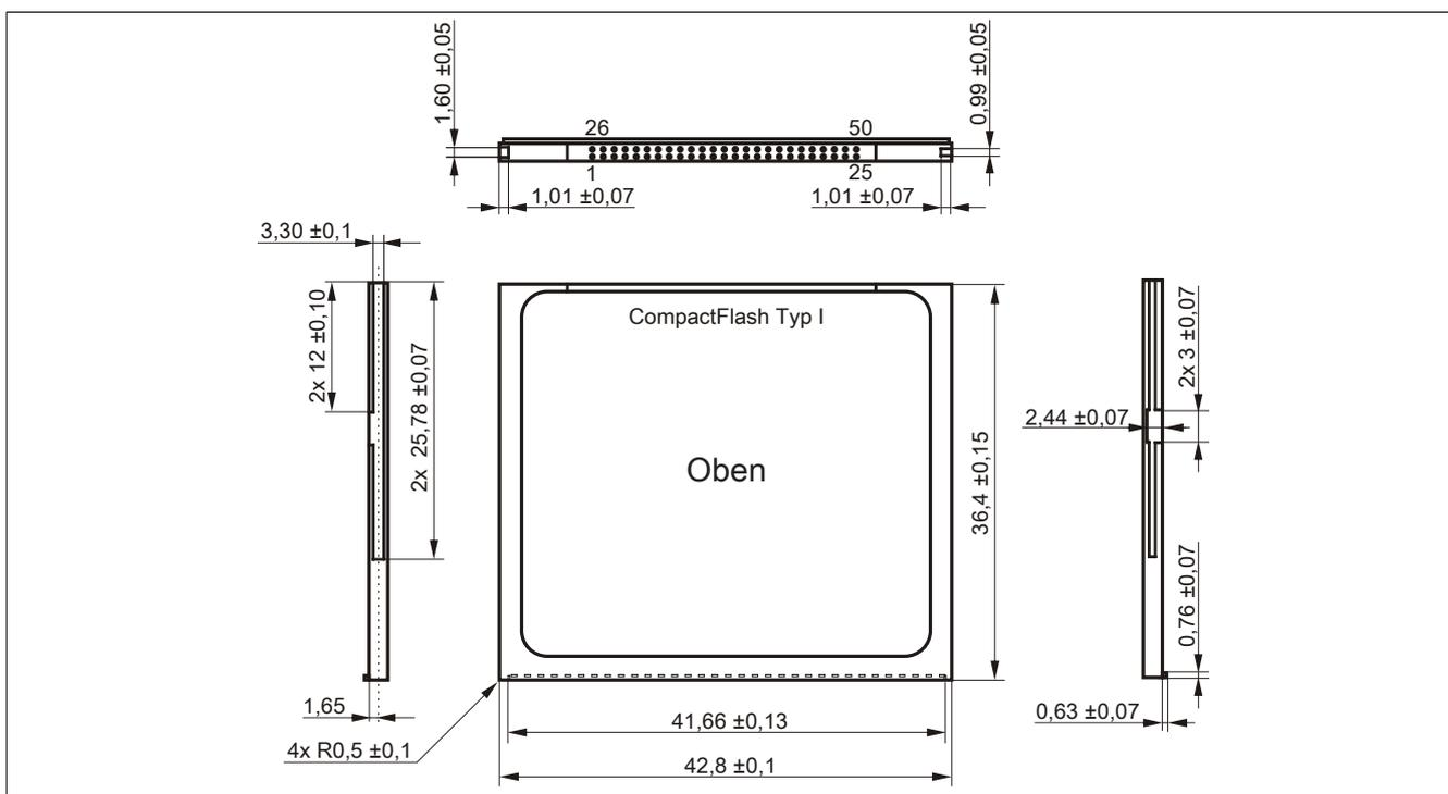
Abbildung 147: Abmessungen CompactFlash Karte Typ I
