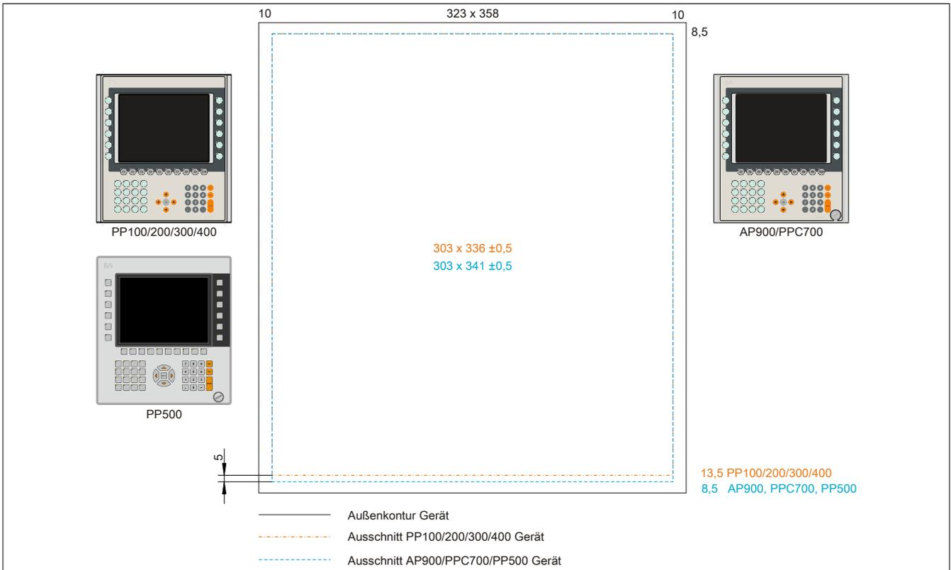
Abbildung 219: Einbaukompatibilität 10,4" Geräte Format Hoch1
