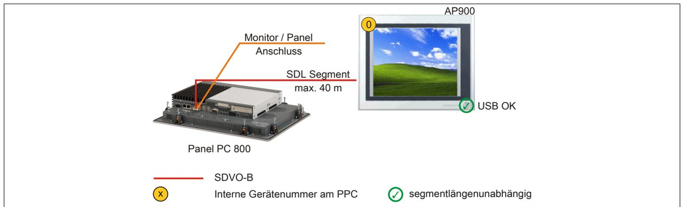
Abbildung 64: Ein Automation Panel 900 über SDL onboard
