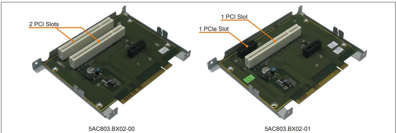
Abbildung 26: 2 Slot Buseinheiten
