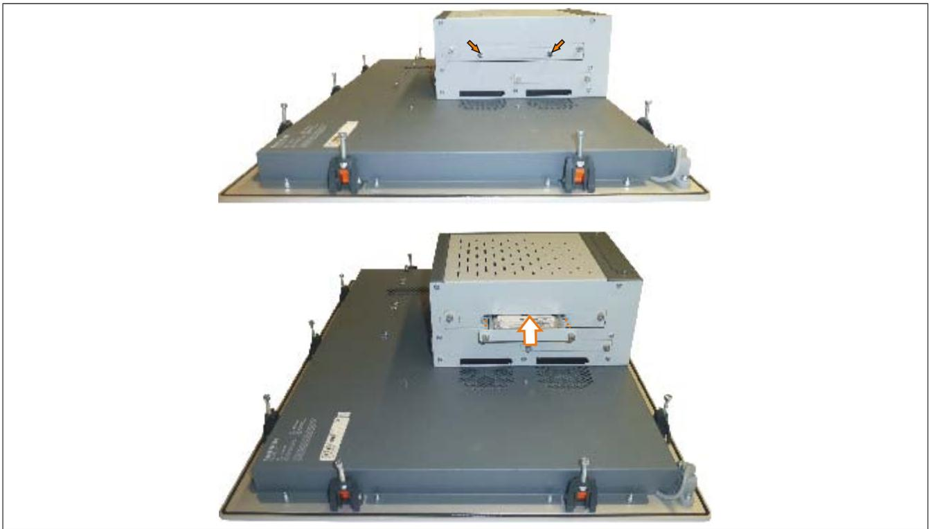
Abbildung 190: Slide-in compact Laufwerk montieren
