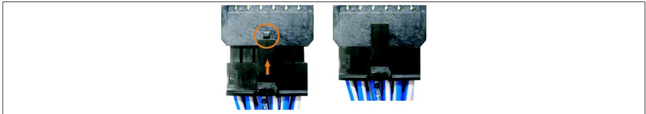
Abbildung 198: Steckerverriegelung
