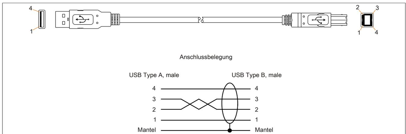
Abbildung 178: 5CAUSB.00xx-00 - Belegung USB Kabel
