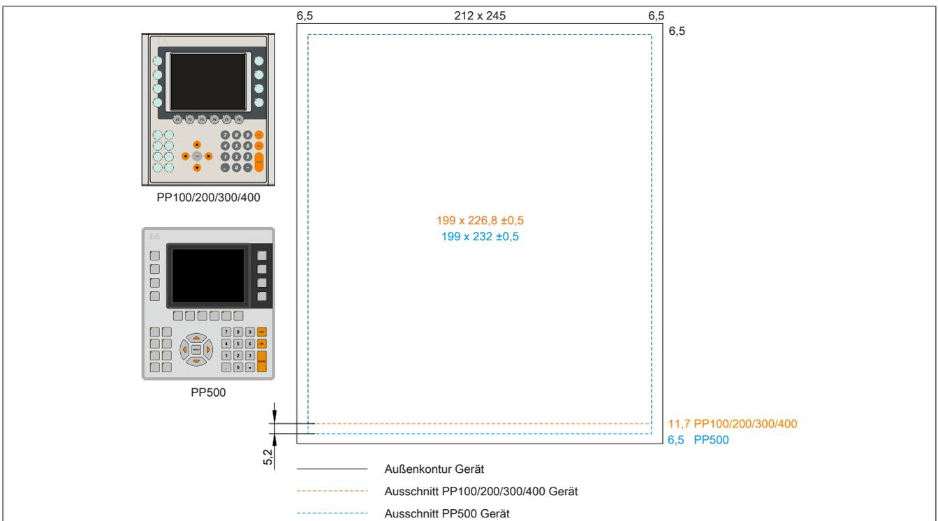
Abbildung 216: Einbaukompatibilität 5,7“ Geräte Format Hoch1
