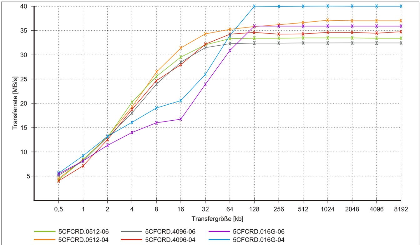
Abbildung 144: ATTO Disk Benchmark v2.34 Vergleich Lesen - 5CFCRD.xxxx-04 mit 5CFCRD.xxxx-06
