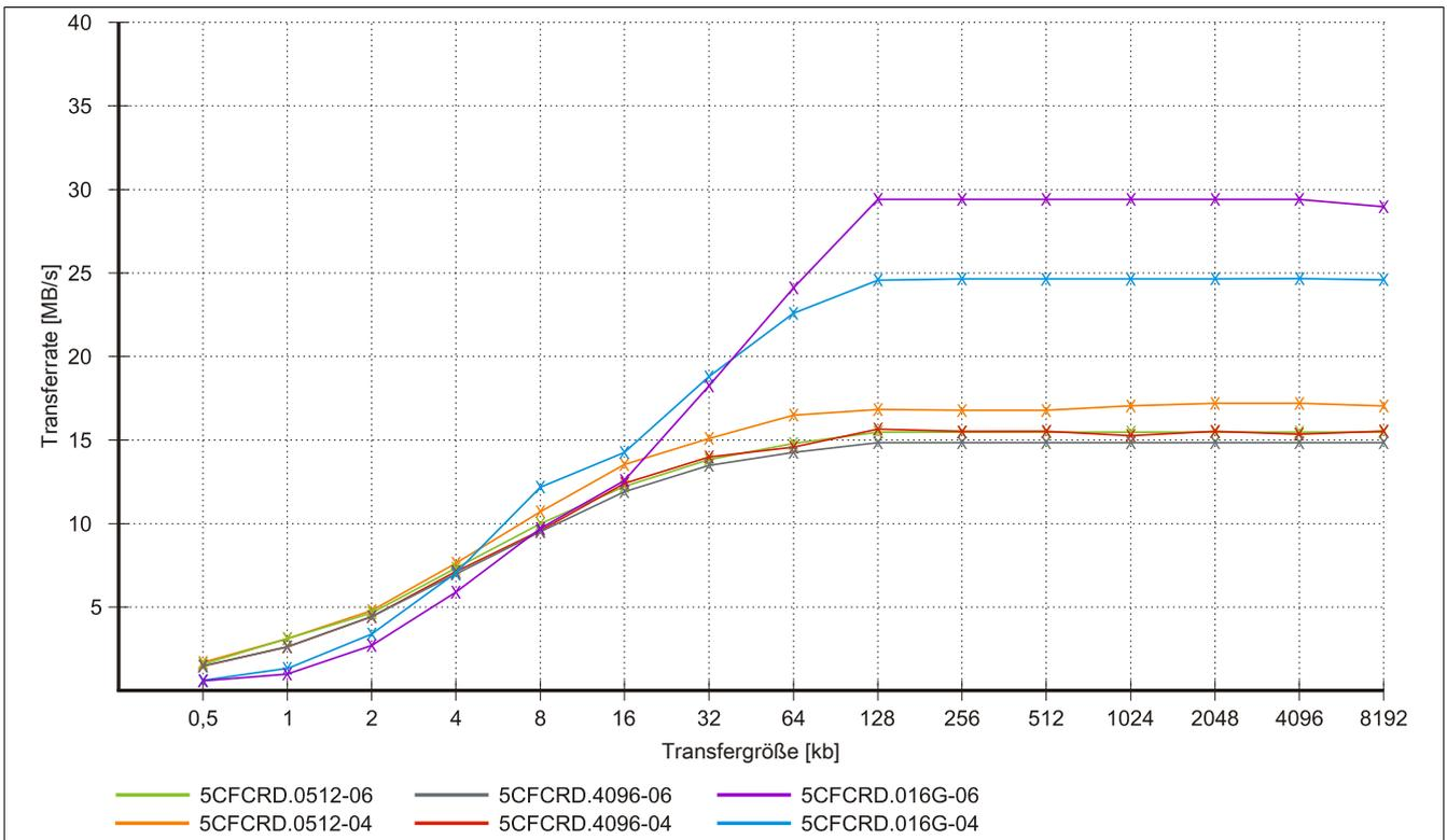
Abbildung 145: ATTO Disk Benchmark v2.34 Vergleich Schreiben - 5CFCRD.xxxx-04 mit 5CFCRD.xxxx-06
