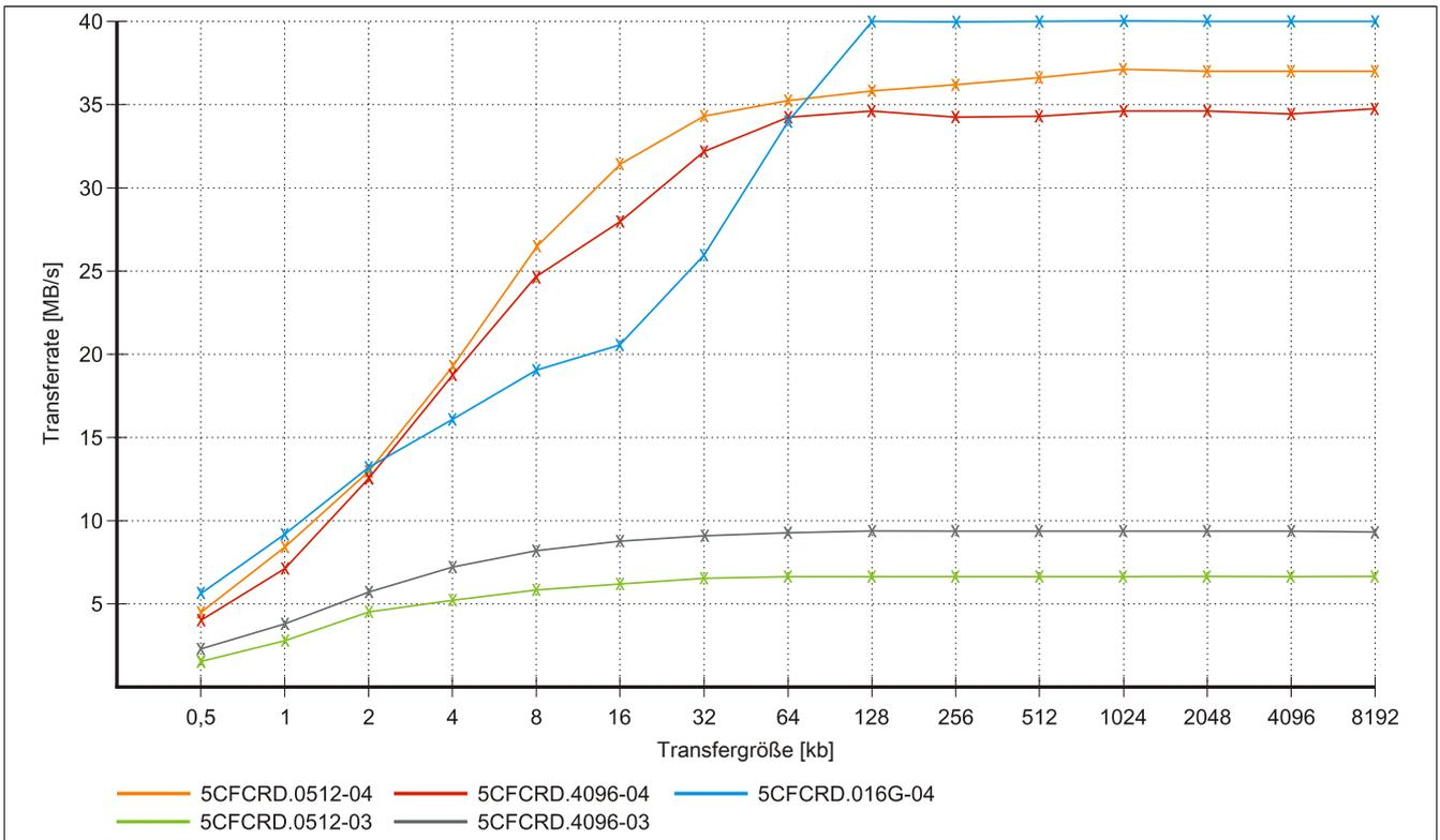
Abbildung 148: ATTO Disk Benchmark v2.34 Vergleich Lesen - 5CFCRD.xxxx-03 mit 5CFCRD.xxxx-04
