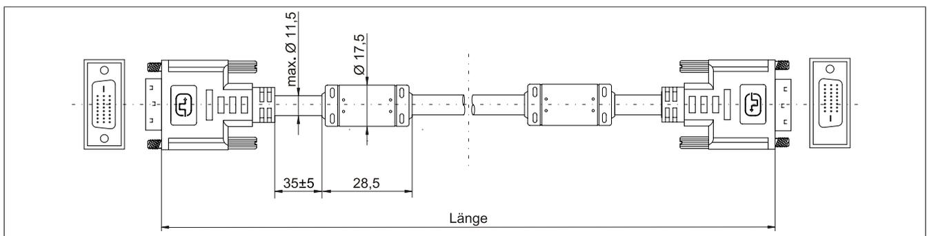
Abbildung 166: 5CASDL.0xxx-00 - Abmessungen
