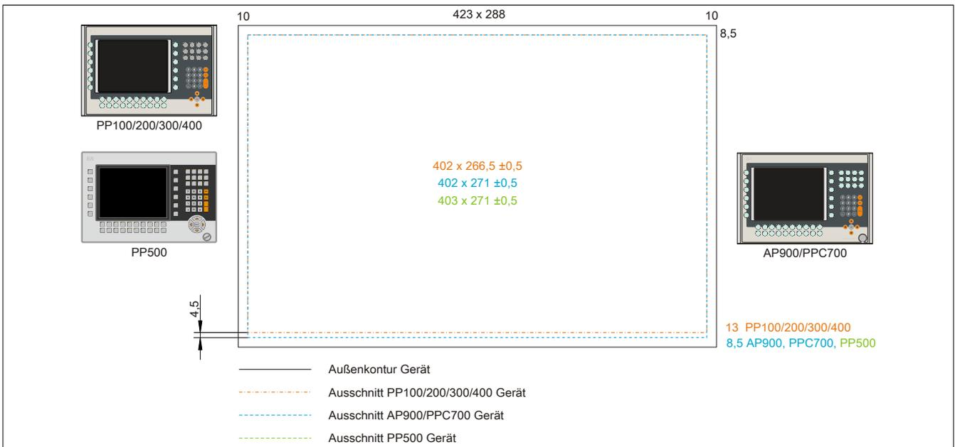
Abbildung 218: Einbaukompatibilität 10,4" Geräte Format Quer2
