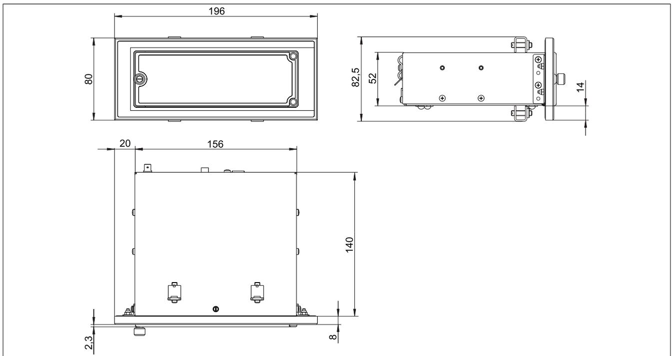
Abbildung 156: Abmessungen USB Media Drive mit Frontklappe
