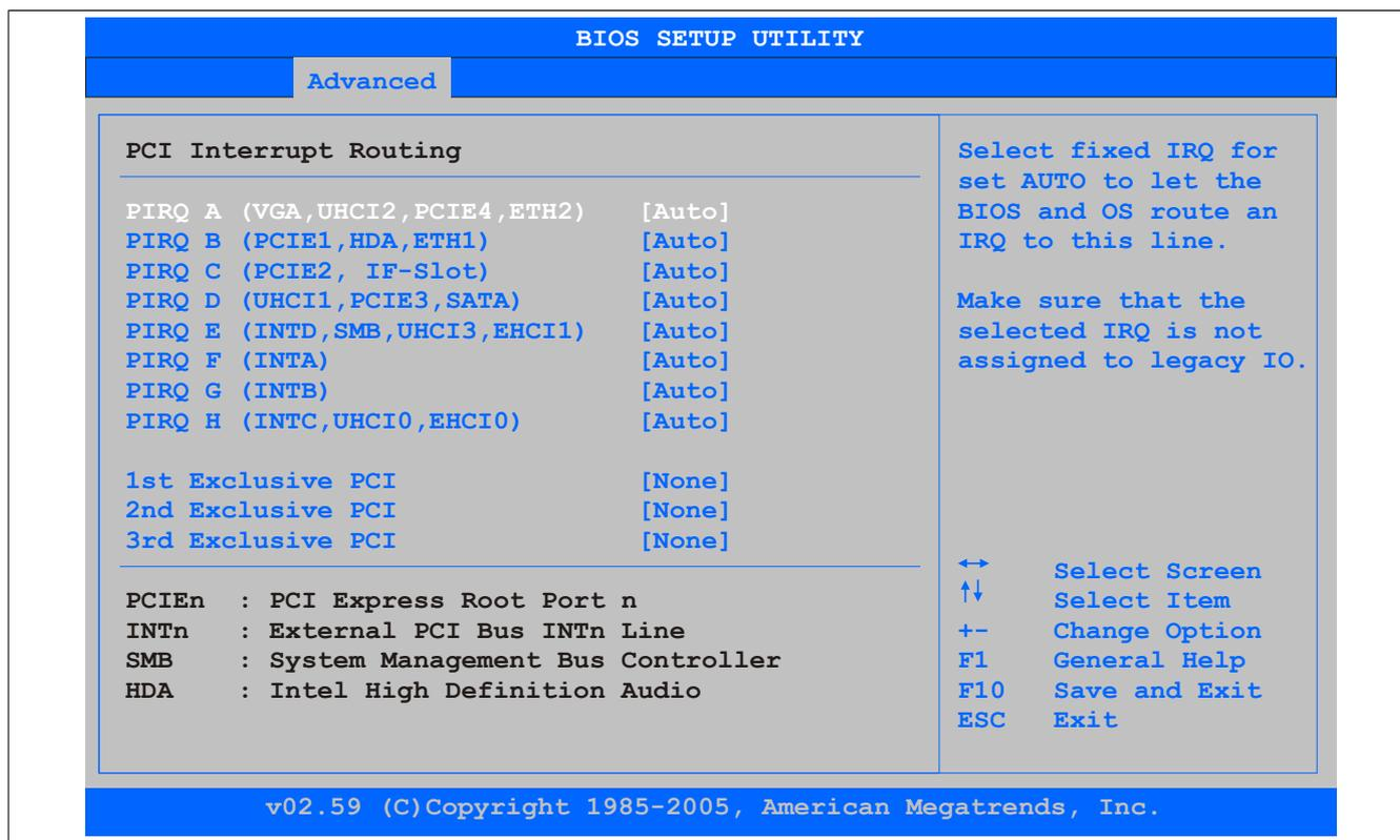
Abbildung 86: GM45 Advanced PCI Interrupt Routing
