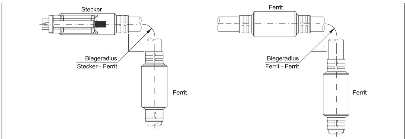
Abbildung 171: Biegeradiusspezifikation
