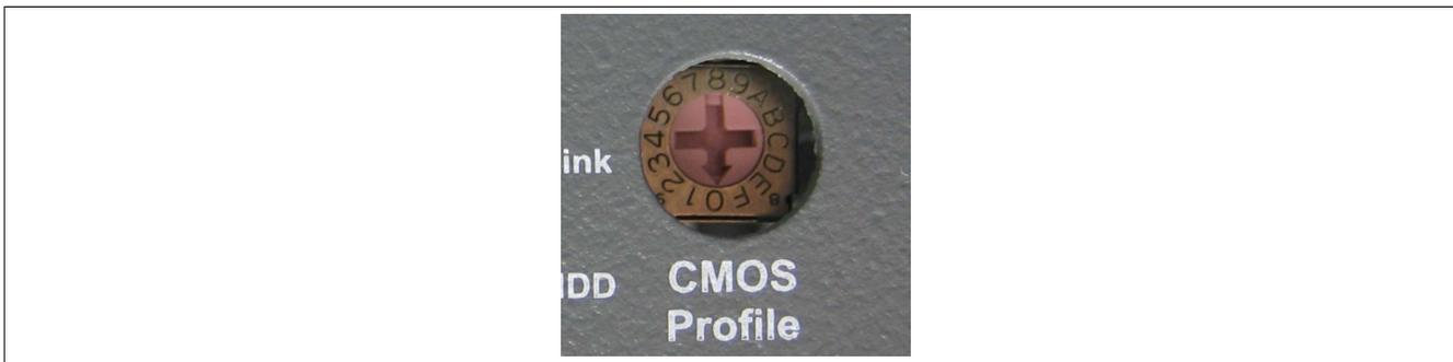
Abbildung 111: CMOS Profile Hex Schalter
