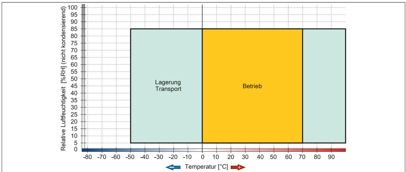
Abbildung 153: 5MMUSB.2048-01 - Temperatur Luftfeuchtediagramm
