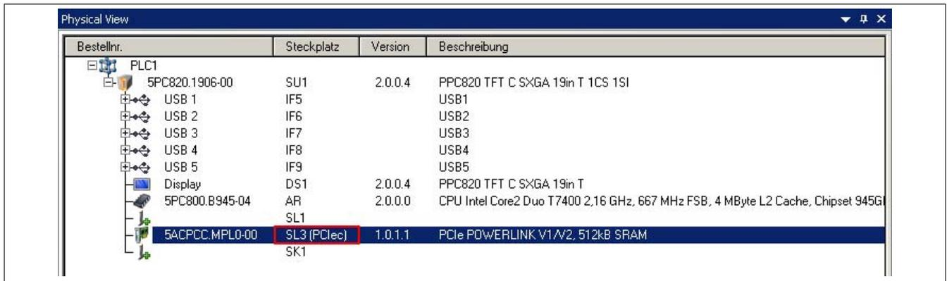
Abbildung 29: Einbinden der POWERLINK Einsteckkarte in Automation Studio
