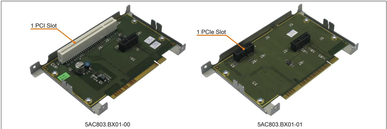
Abbildung 25: 1 Slot Buseinheiten
