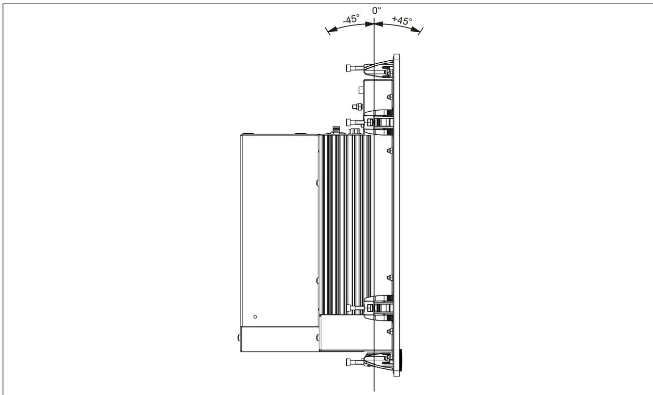
Abbildung 55: Einbaulage 0° und +/-45°
