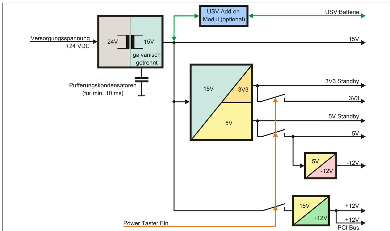
Abbildung 4: Blockschaltbild Spannungsversorgung
