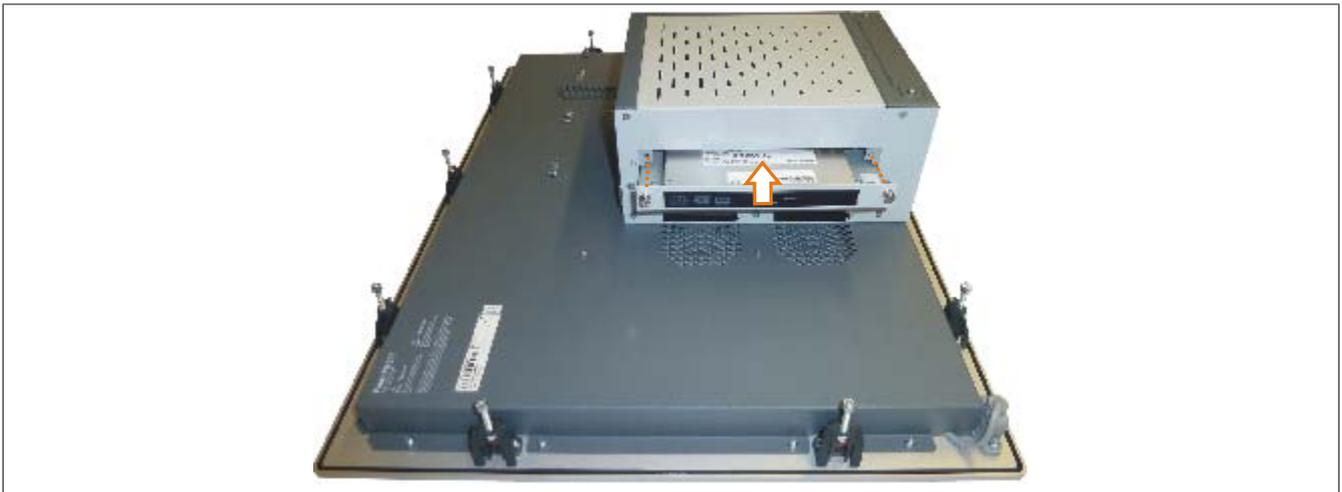
Abbildung 187: Slide-in Laufwerkseinbau
