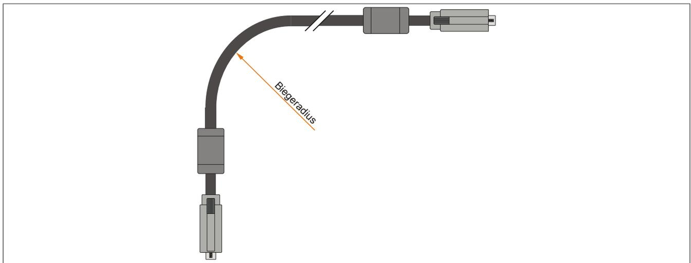
Abbildung 59: Biegeradius Kabelanschluss
