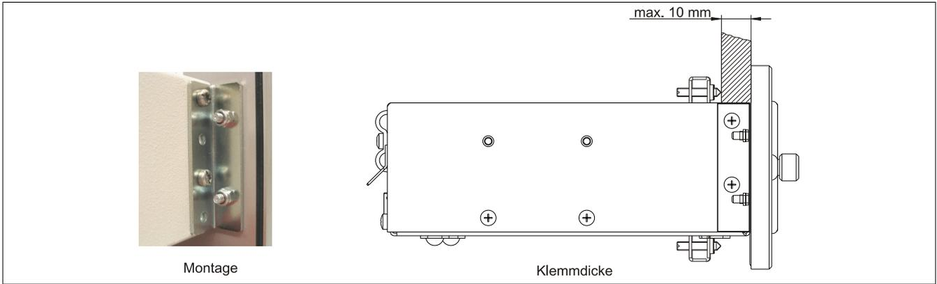
Abbildung 160: Frontklappenmontage und Klemmdicke
