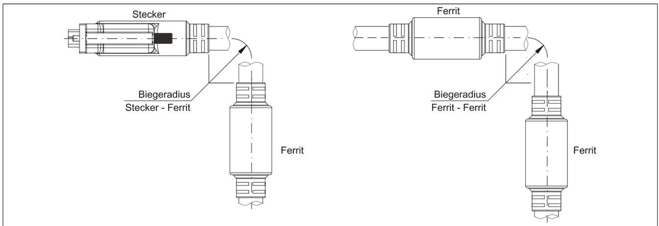
Abbildung 168: Biegeradiusspezifikation
