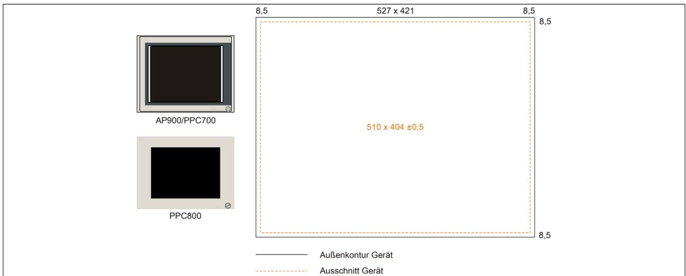
Abbildung 224: Einbaukompatibilität 19" Geräte Quer1
