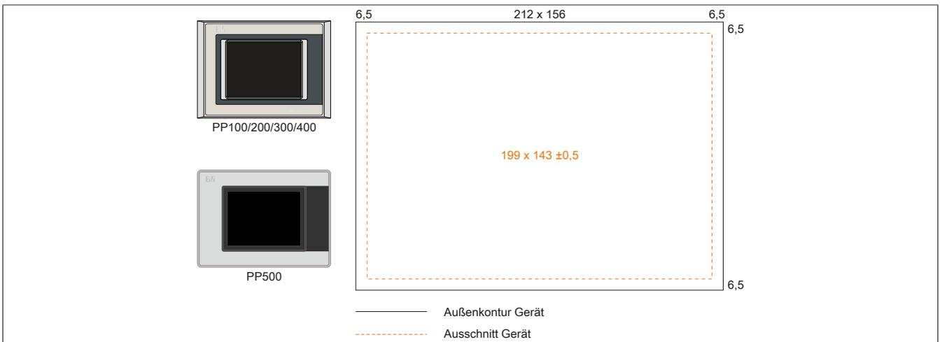
Abbildung 214: Einbaukompatibilität 5,7" Geräte Format Quer1
