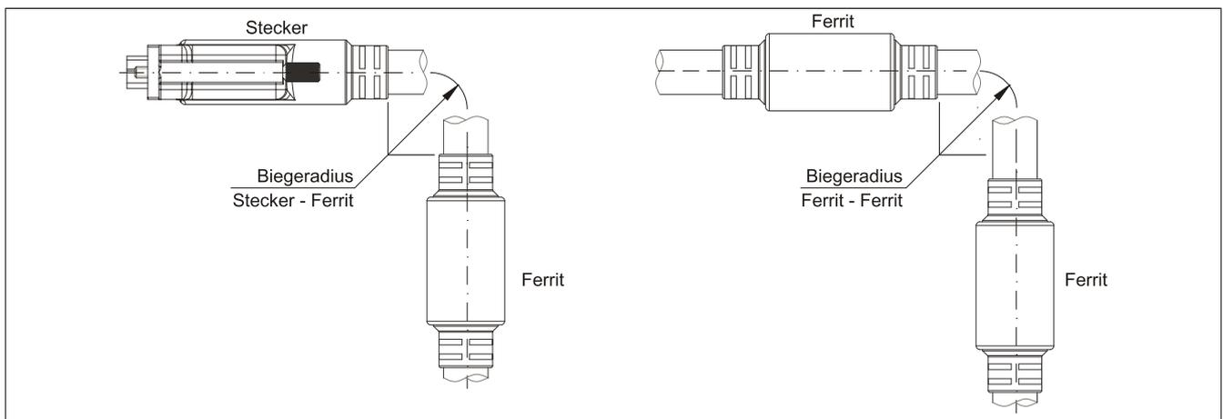
Abbildung 174: Biegeradiusspezifikation
