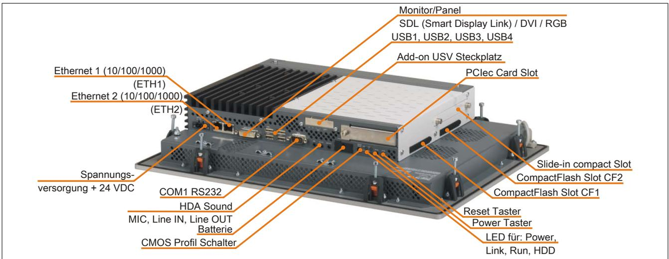
Abbildung 13: 5PC820.1505-00 - Rückansicht
