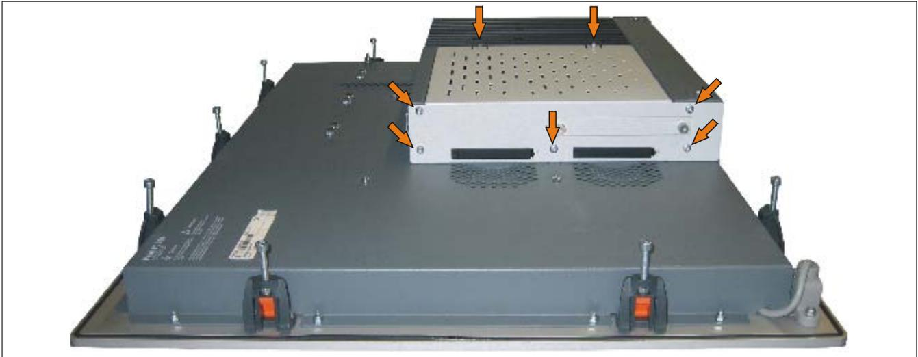
Abbildung 206: PPC800 Seitendeckeldemontage ohne Expansion
