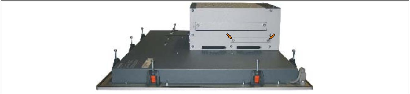
Abbildung 184: Schnellverschlusschrauben lösen
