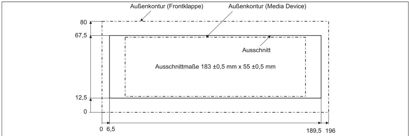
Abbildung 157: Einbauausschnitt USB Media Drive mit Frontklappe
