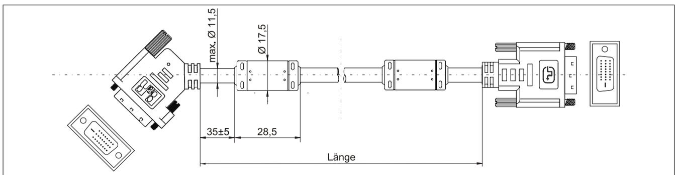
Abbildung 169: 5CASDL.0xxx-01 - Abmessungen
