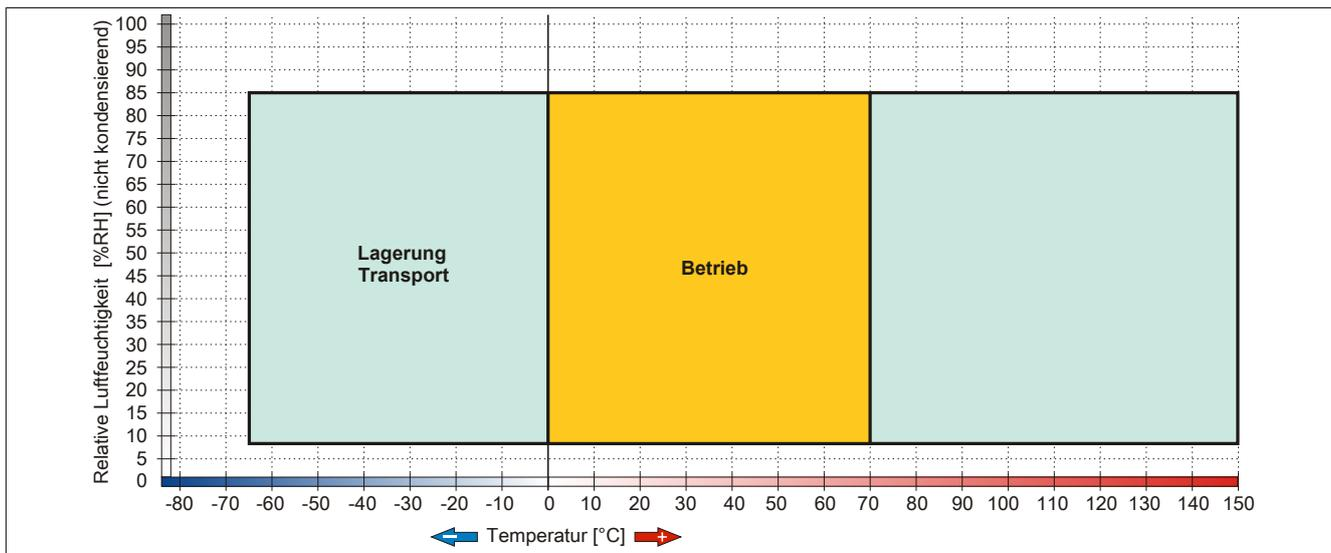
Abbildung 146: 5CFCRD.xxxx-04 - Temperatur Luftfeuchtediagramm CompactFlash Karten
