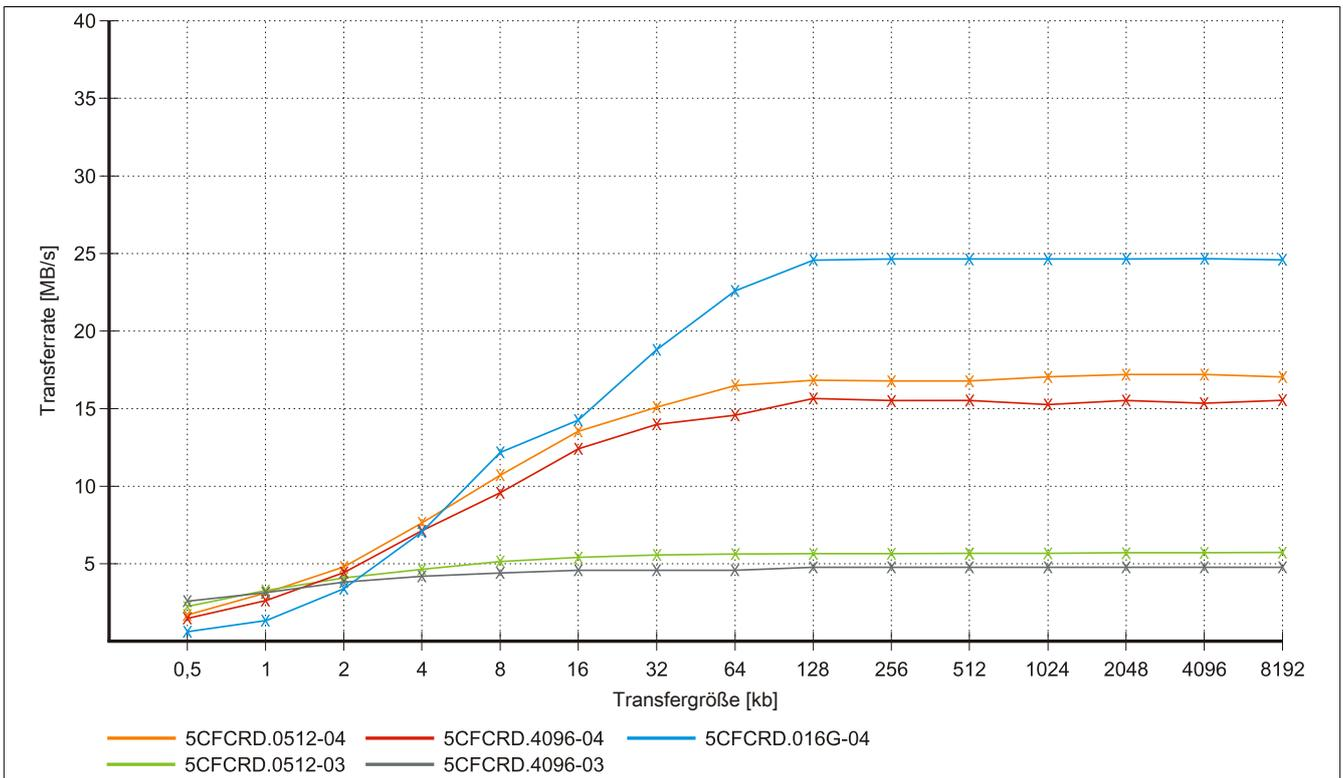
Abbildung 149: ATTO Disk Benchmark v2.34 Vergleich Schreiben - 5CFCRD.xxxx-03 mit 5CFCRD.xxxx-04
