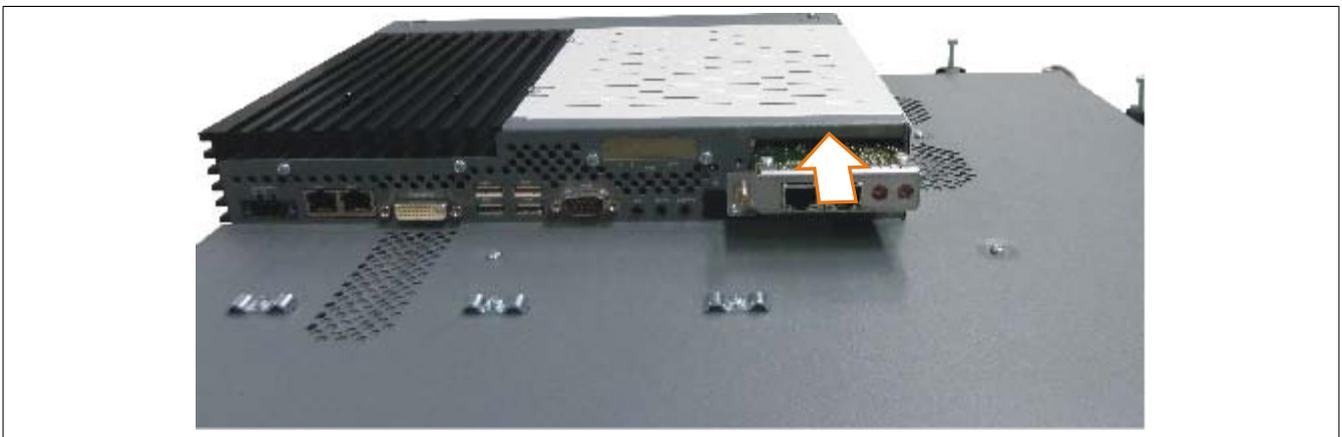
Abbildung 205: PCIec Einsteckkarte einbauen
