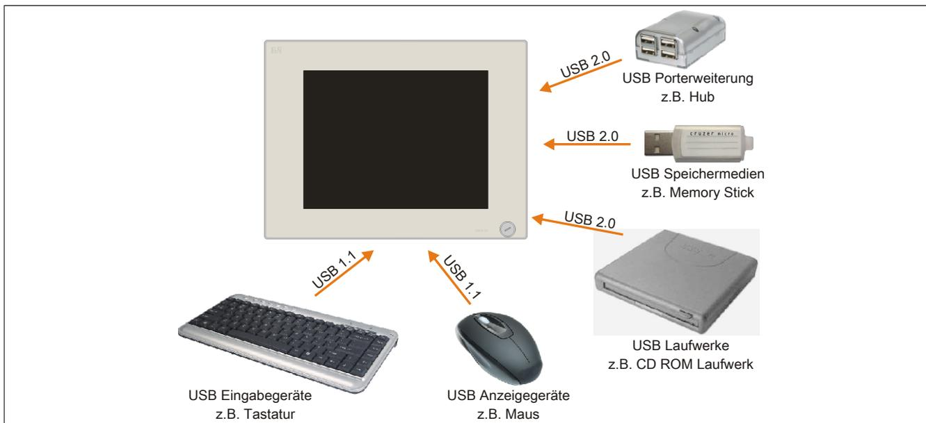
Abbildung 68: Anschluss von USB Peripheriegeräten lokal am PPC800
