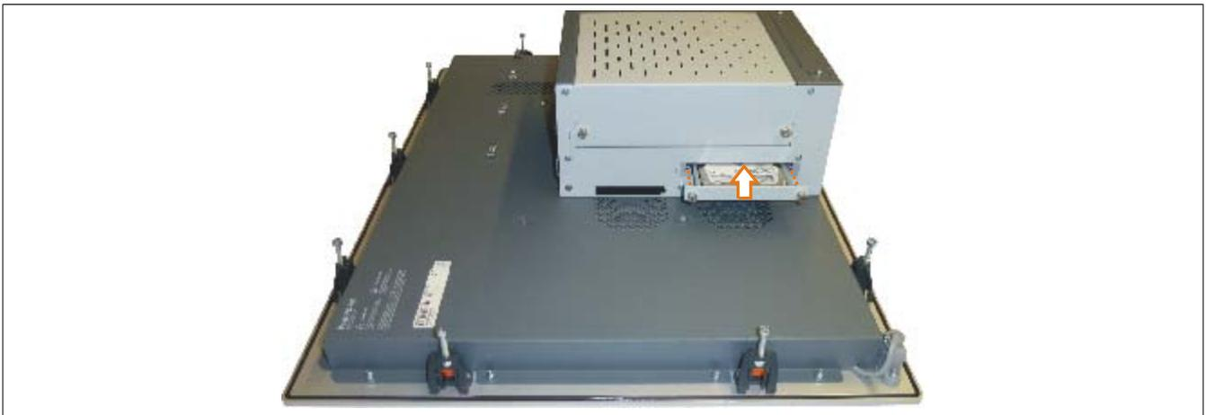
Abbildung 185: Compact SATA Laufwerk einschieben
