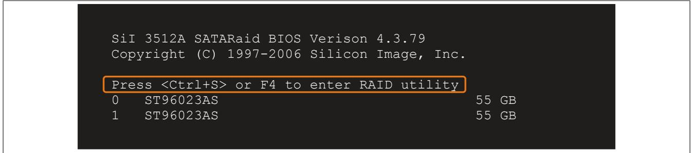
Abbildung 71: Einstieg in das RAID Configuration Utility
