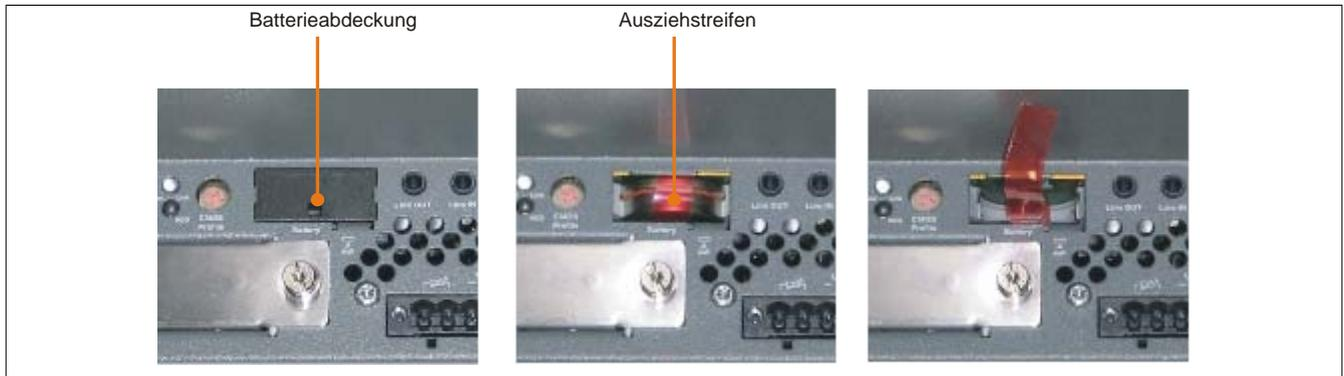
Abbildung 180: Batterie entfernen
