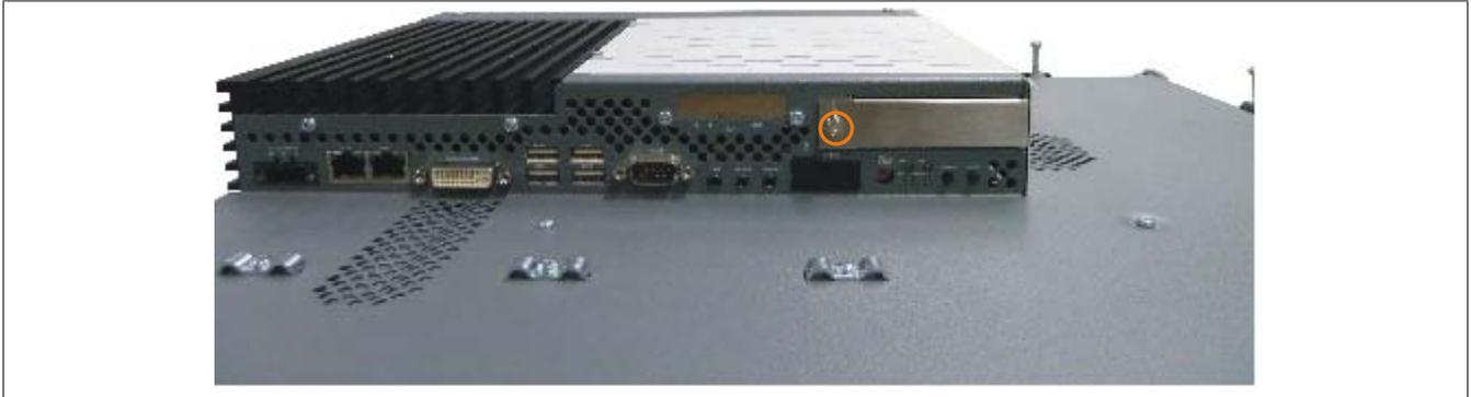
Abbildung 204: PCIec Modulabdeckung entfernen
