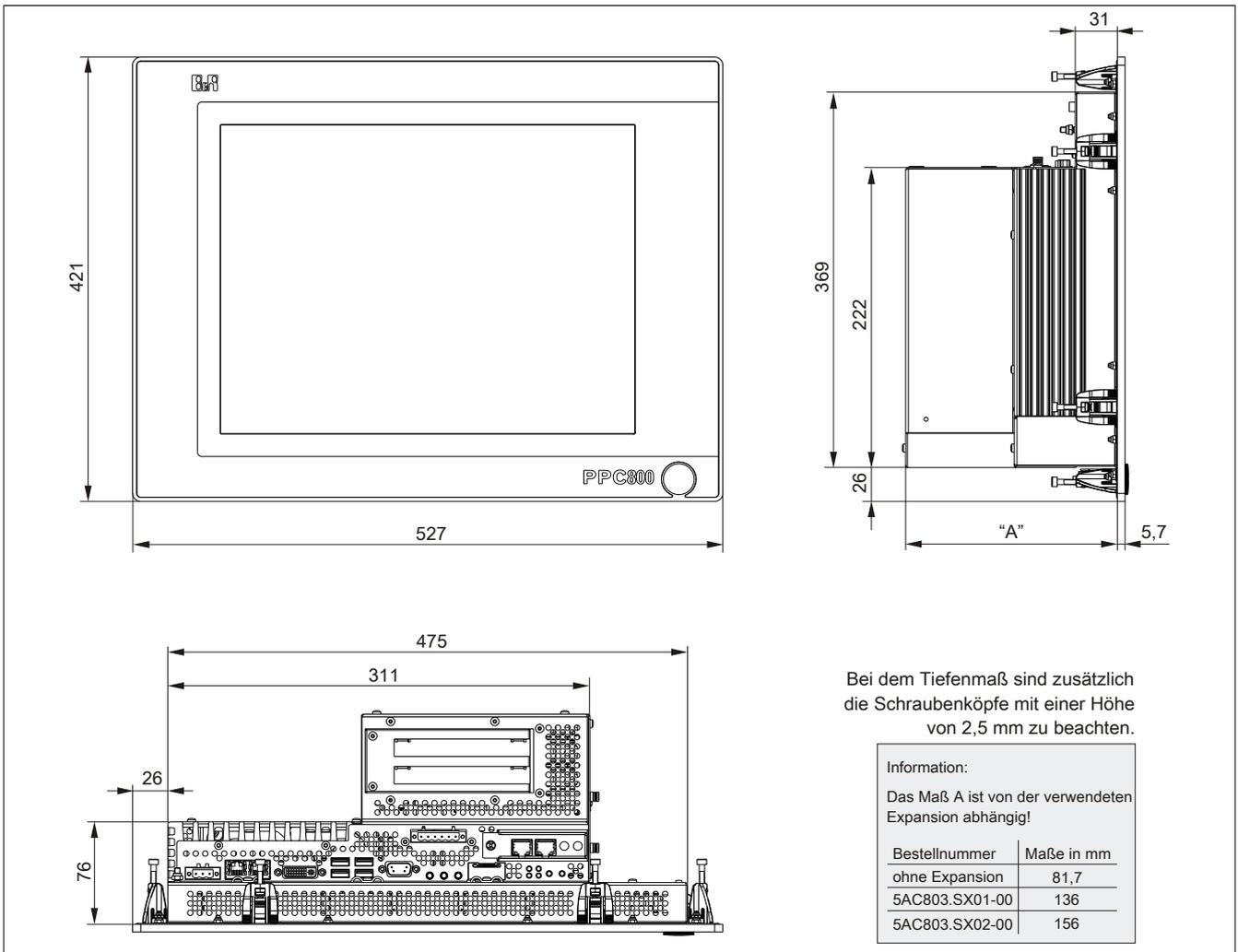
Abbildung 18: 5PC820.1906-00 - Abmessungen
