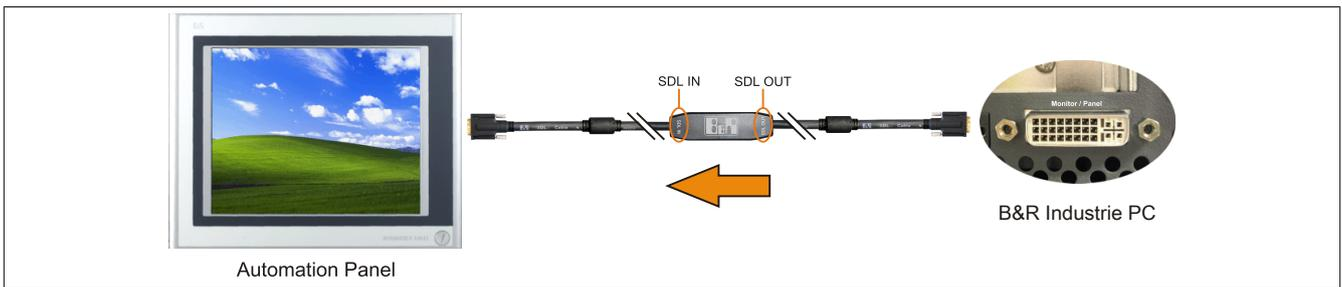
Abbildung 177: Beispiel für die Signalrichtung für das SDL Kabel flex mit Extender
