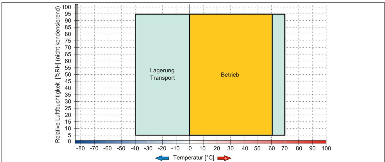
Abbildung 50: 5MMHDD.0500-00 - Temperatur Luftfeuchtediagramm
