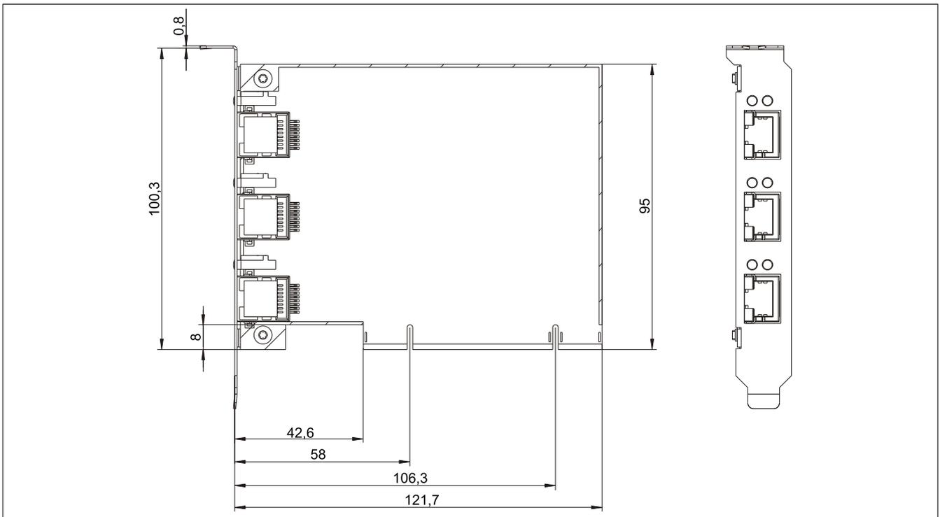
Abbildung 141: 5ACPCI.ETH3-01 - Abmessungen
