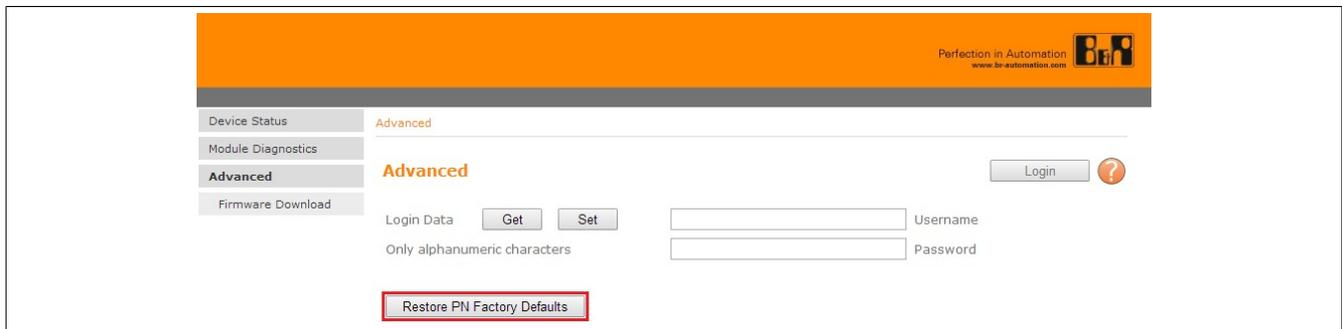
Außerdem erscheint der Button **Restore PN Factory Defaults**. Dieser löscht den Flash des Bus Controllers und versetzt ihn in seinen Auslieferungszustand zurück. Er verhält sich also gleich wie die Knotennummerstellung 0xF0.
