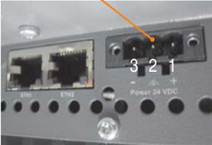
Tabelle 25: Spannungsversorgungsanschluss Power 24 VDC
