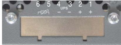
Tabelle 33: Add-on USV Steckplatz (ohne und mit montierter USV)
