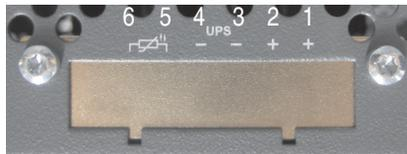
Tabelle 33: Add-on USV Steckplatz (ohne und mit montierter USV)
