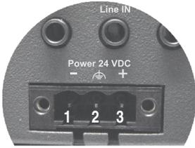
Tabelle 21: Spannungsversorgungsanschluss Power 24 VDC
