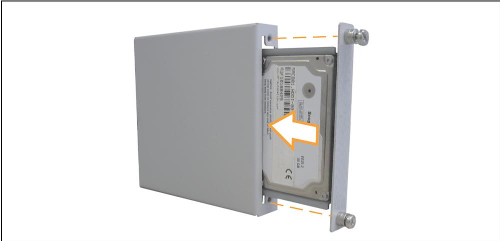
Abbildung 282: Montage der Ersatz Hard Disk an der Ersatzdiskablage
