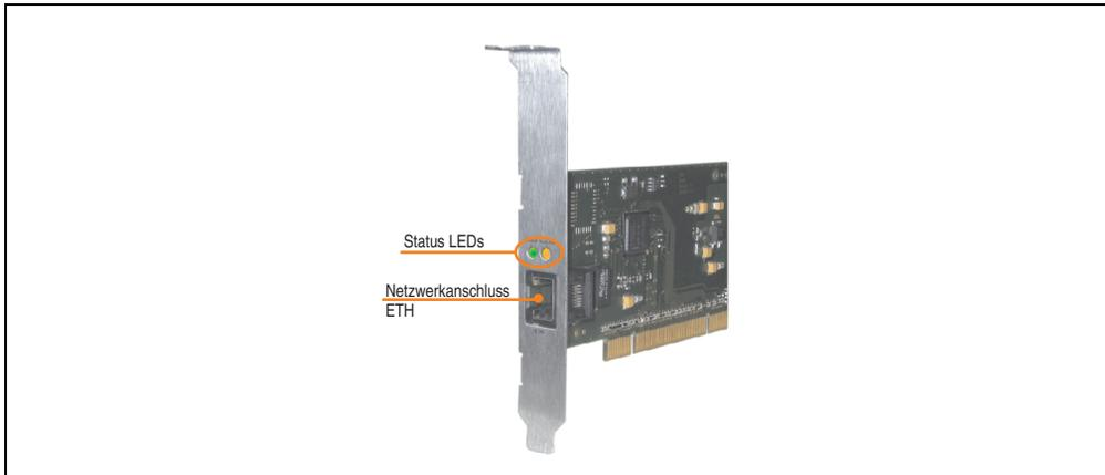
Abbildung 193: PCI Ethernet Card 10/100 - 5ACPCI.ETH1-01
