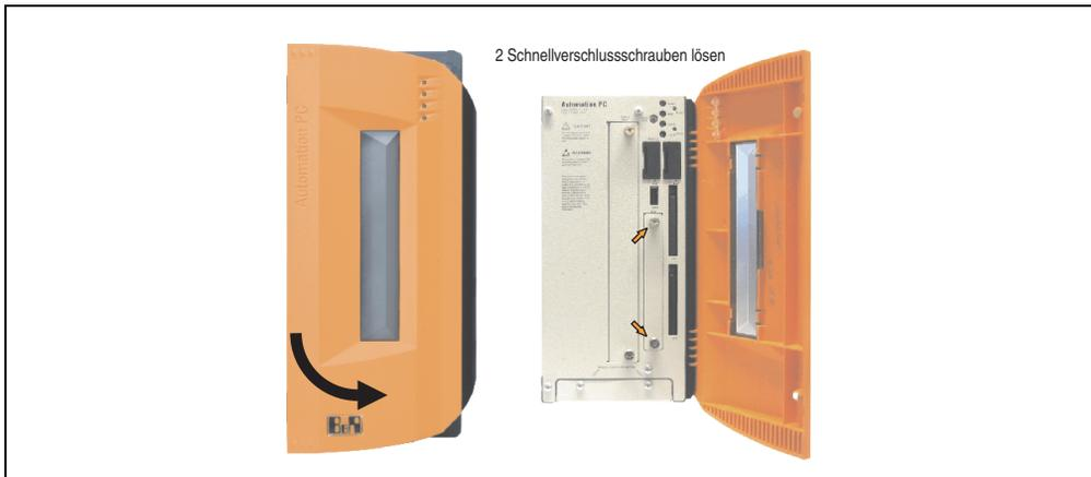
Abbildung 230: Schnellverschlusschrauben lösen
