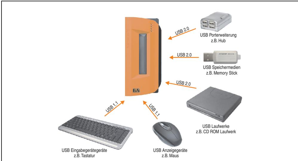
Abbildung 100: Anschluss von USB Peripheriegeräten lokal am APC810
