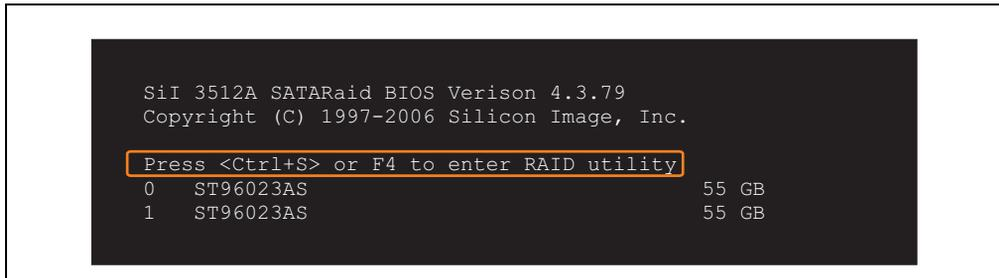
Abbildung 103: Einstieg in das RAID Configuration Utility
