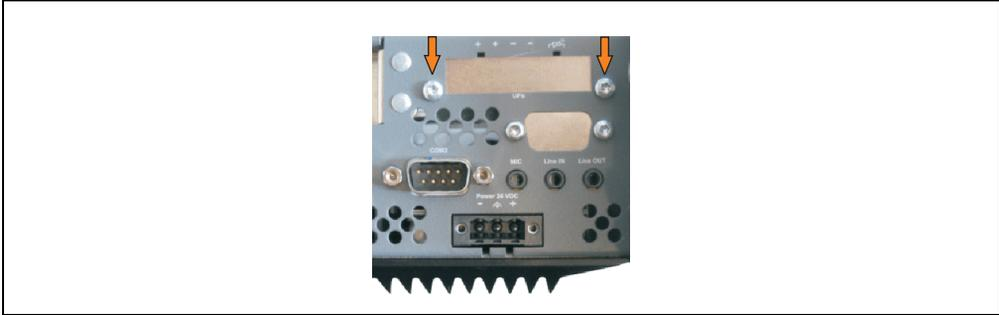
Abbildung 258: USV Modulabdeckung entfernen
