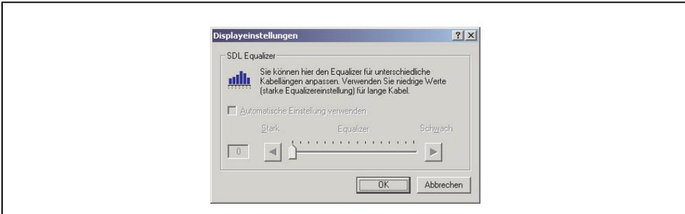
Abbildung 159: ADI Control Center SDL Equalizer Einstellung
