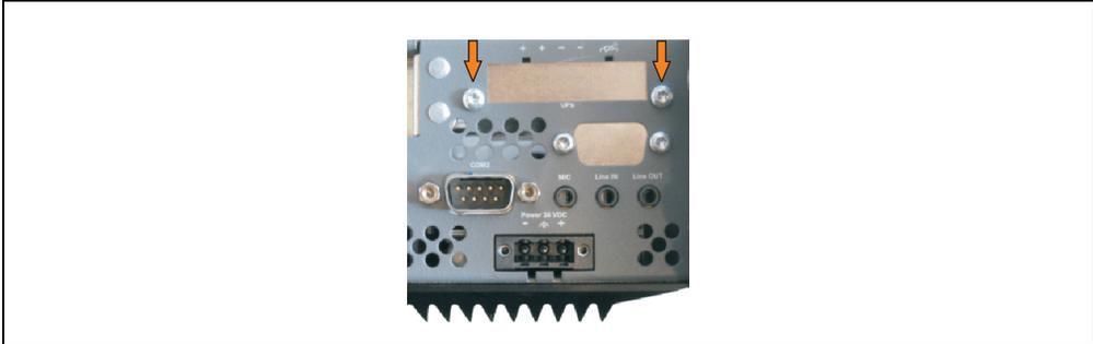
Abbildung 284: USV Modulabdeckung entfernen
