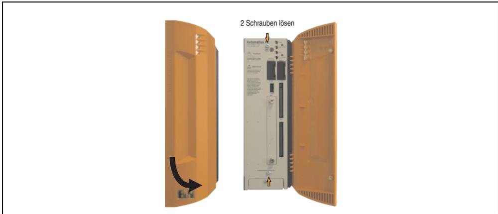
Abbildung 261: APC810 1 Card Slot Seitendeckeldemontage
