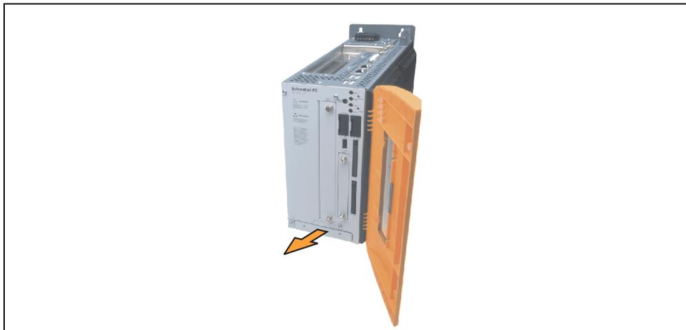
Abbildung 223: Lüfter Kit Einschub entfernen
