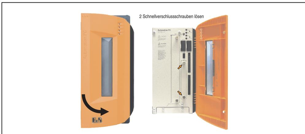
Abbildung 216: Schnellverschlusschrauben lösen
