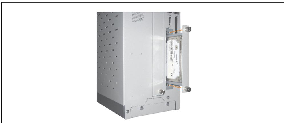
Abbildung 217: Compact SATA Laufwerk einschieben
