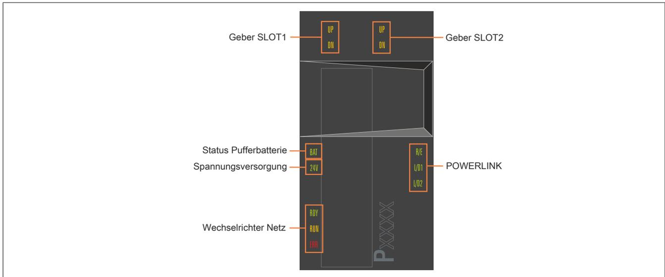
Abbildung 1: Anzeigengruppen Leistungsversorgungsmodule 8BVP
