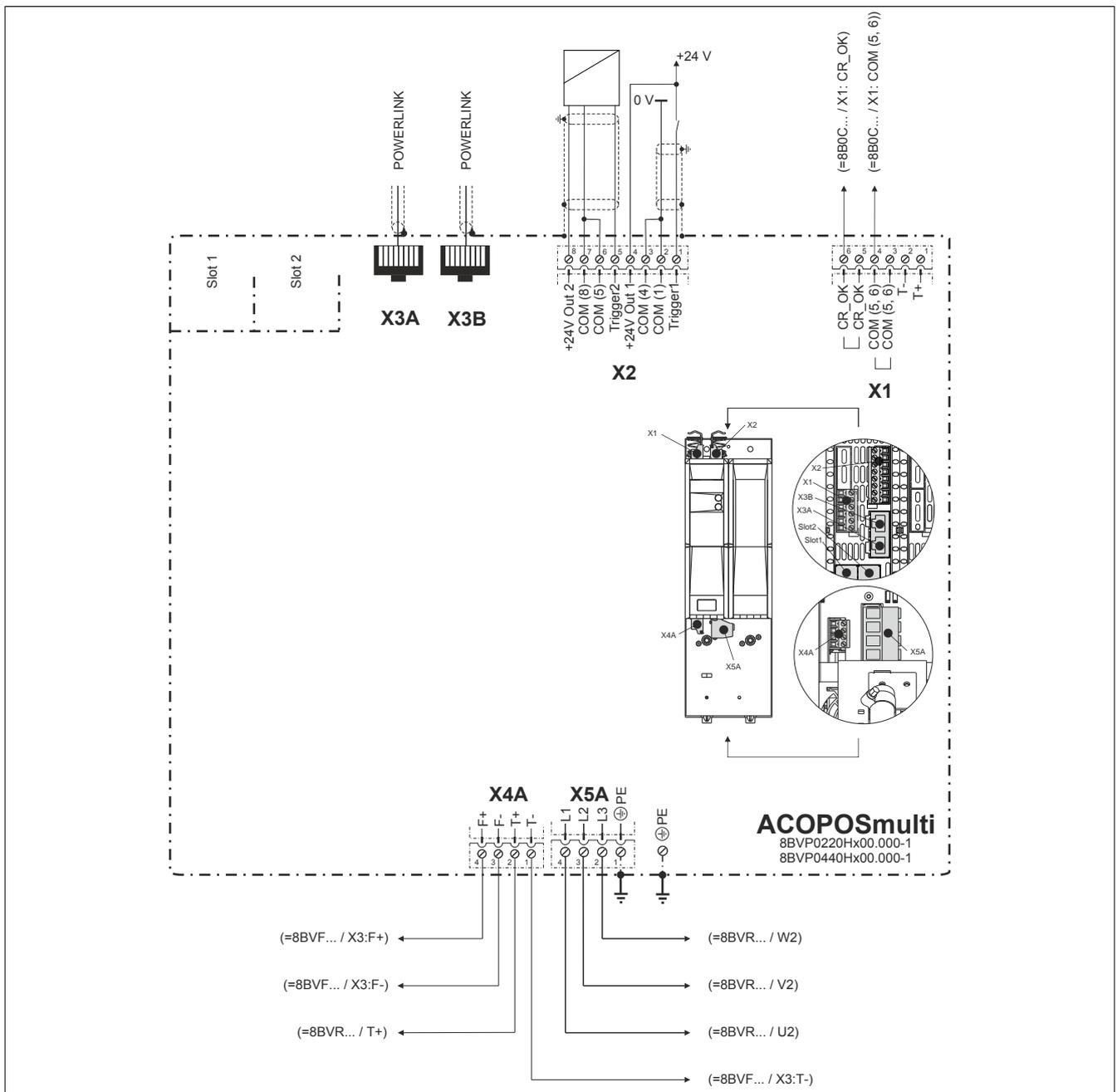
Abbildung 3: Übersicht Anschlussbelegungen 8BVP0220Hx00.000-1, 8BVP0440Hx00.000-1
