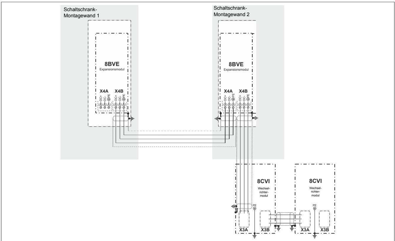
Abbildung 7: Wechselrichtermodule 8CVI auf dem letzten Expansionsmodul 8BVE
