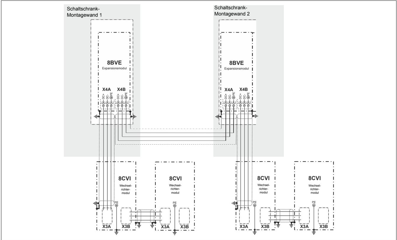
Abbildung 6: Wechselrichtermodul 8CVI auf beiden Expansionsmodulen 8BVE
