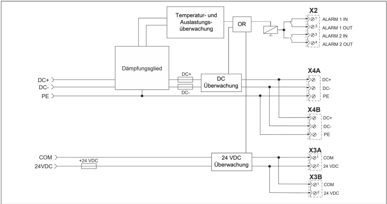
Abbildung 8: Ein-/Ausgangsschema Expansionsmodule 8BVE
