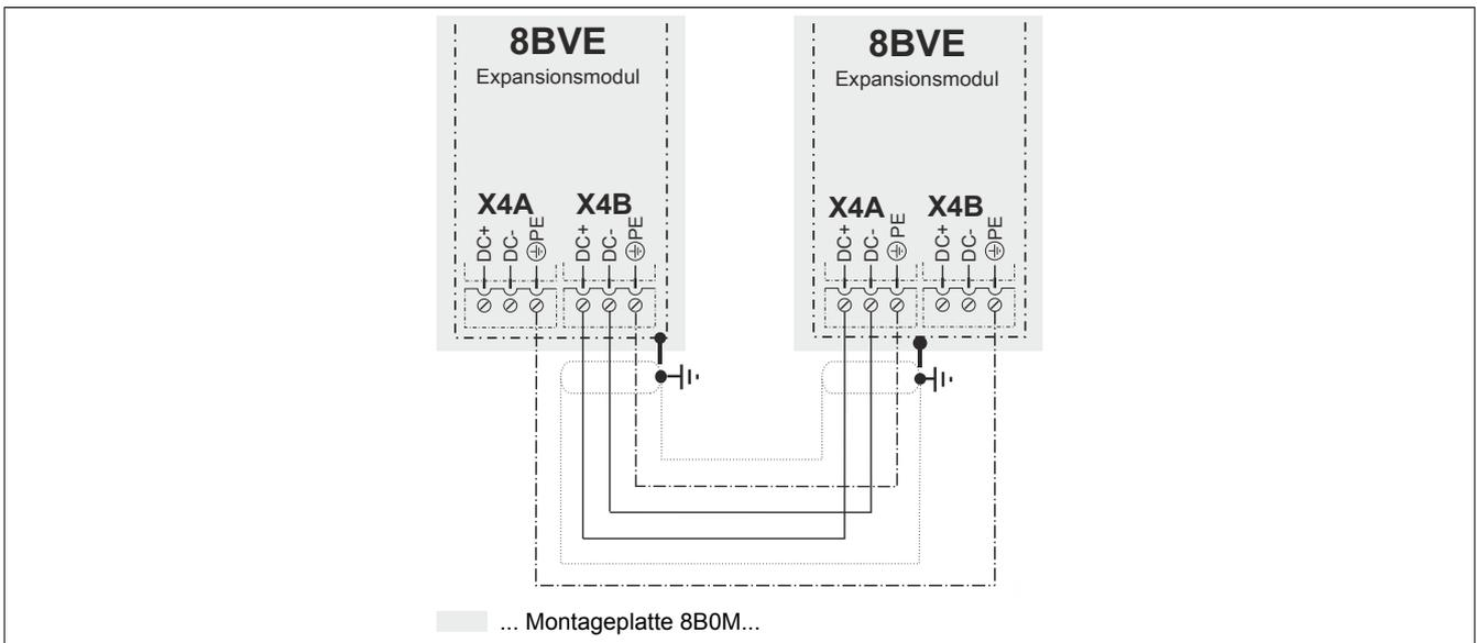
Abbildung 4: DC-Verbindung zwischen zwei Expansionsmodulen 8BVE
