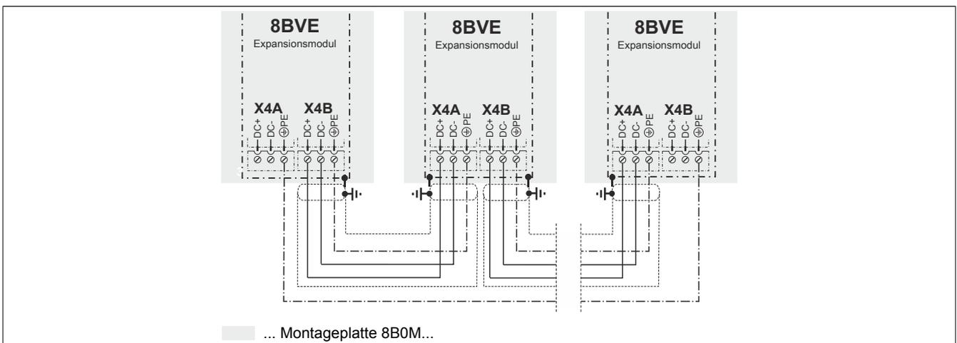
Abbildung 5: DC-Verbindung zwischen Expansionsmodulen 8BVE
