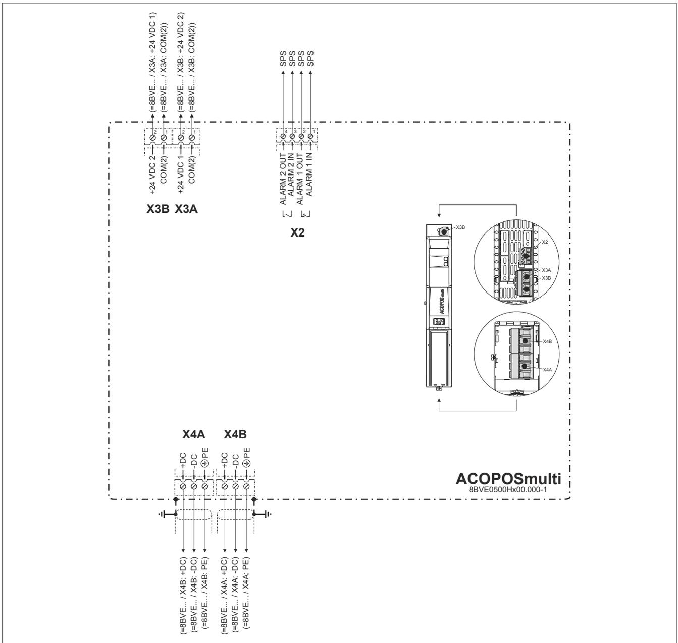
Abbildung 3: Übersicht Anschlussbelegungen 8BVE0500Hx00.000-1
