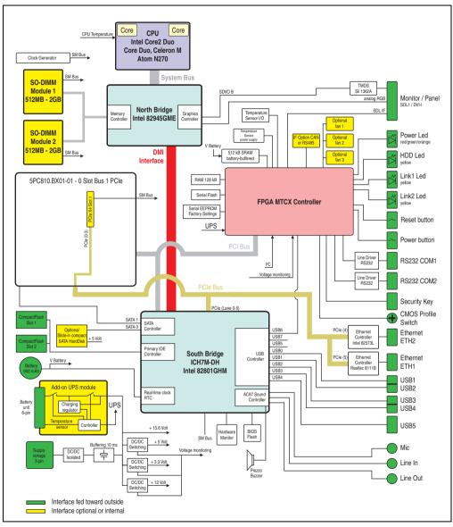
Figure 33: Block diagram 5PC810.SX01-00 + 5PC810.BX01-01
