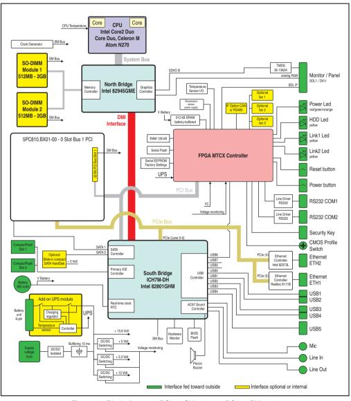
Figure 32: Block diagram 5PC810.SX01-00 + 5PC810.BX01-00
