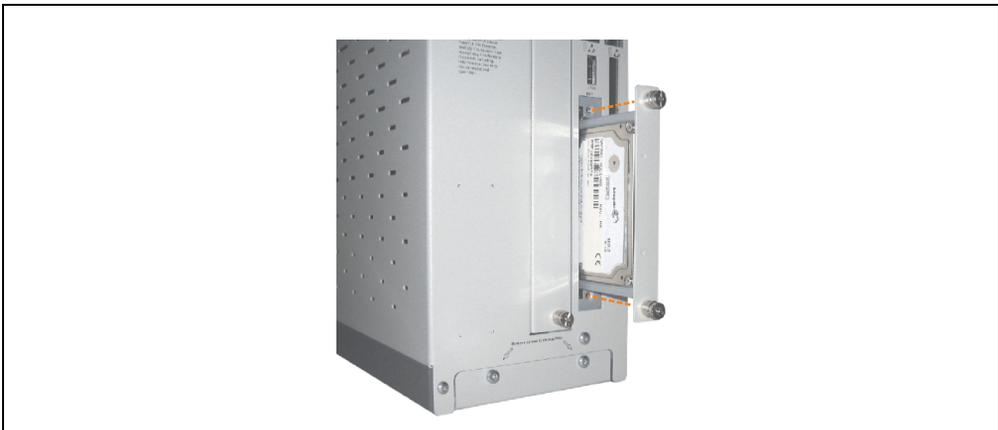
Abbildung 192: Compact SATA Laufwerk einschieben
