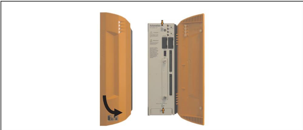
Abbildung 236: APC810 1 Card Slot Seitendeckeldemontage
