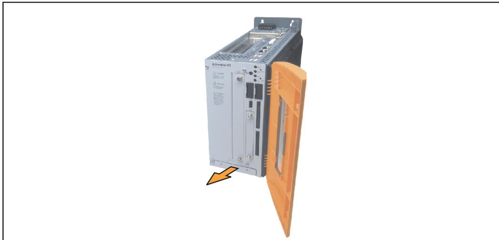
Abbildung 198: Lüfter Kit Einschub entfernen
