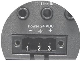
Tabelle 18: Spannungsversorgungsanschluss Power 24 VDC
