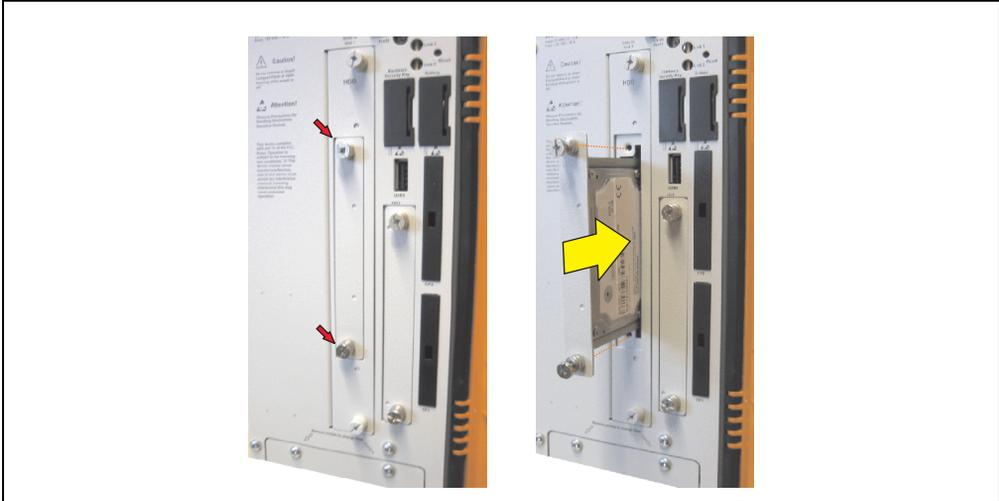
Abbildung 145: Slide-In Compact Laufwerk montieren
