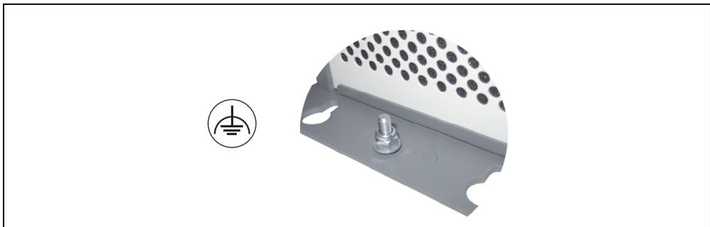
Abbildung 11: Erdungsanschluss
