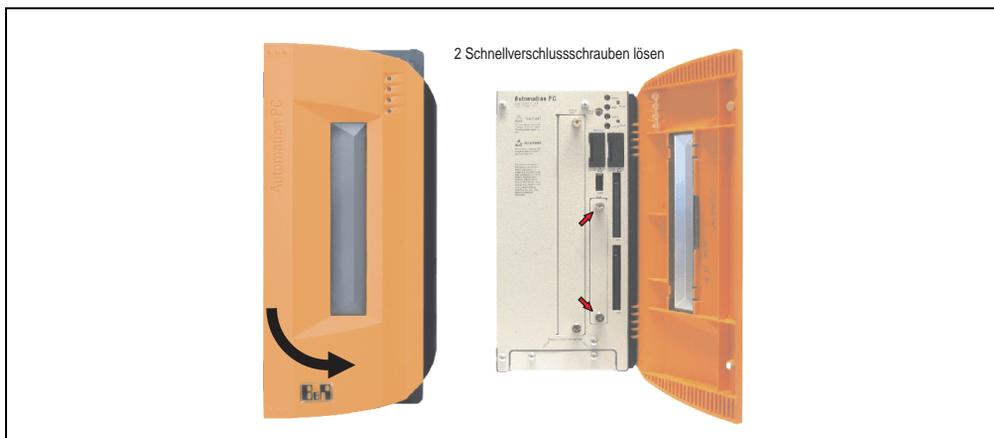
Abbildung 139: Schnellverschlusschrauben lösen
