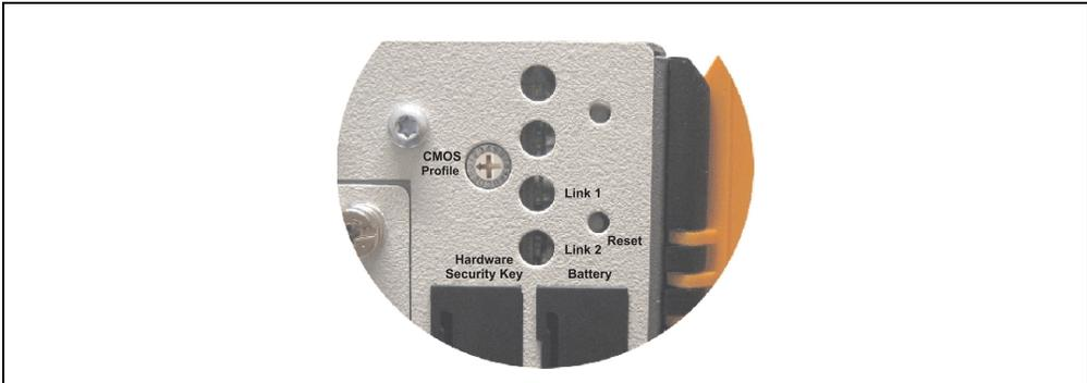
Abbildung 93: CMOS Profile Hex Schalter
