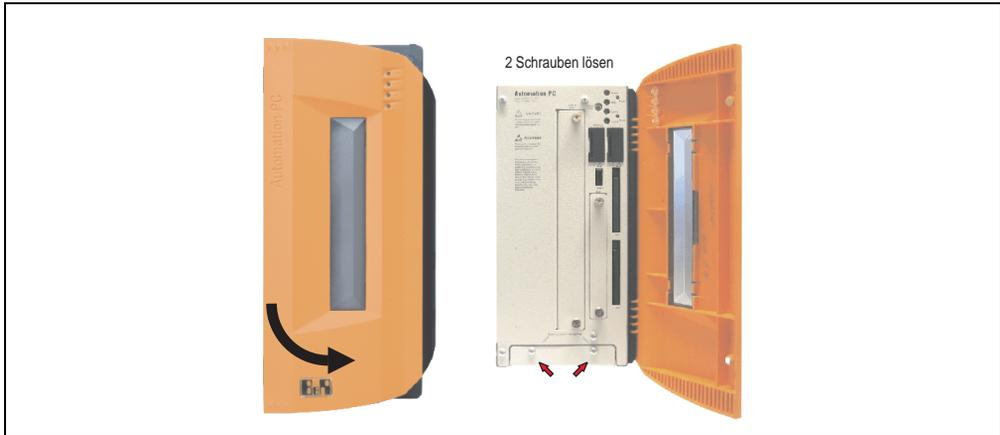
Abbildung 146: APC810 2 Card Slot - Schrauben für den Filterkit Ein- und Ausbau lösen
