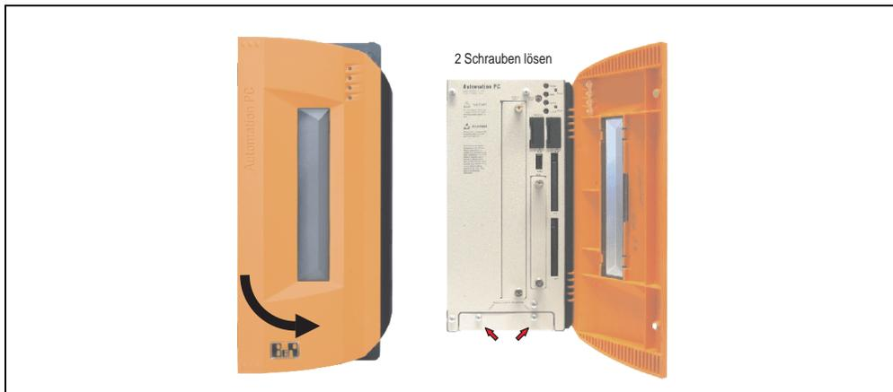
Abbildung 127: APC810 2PCI Slot - Schrauben für den Filterkit Ein- und Ausbau lösen
