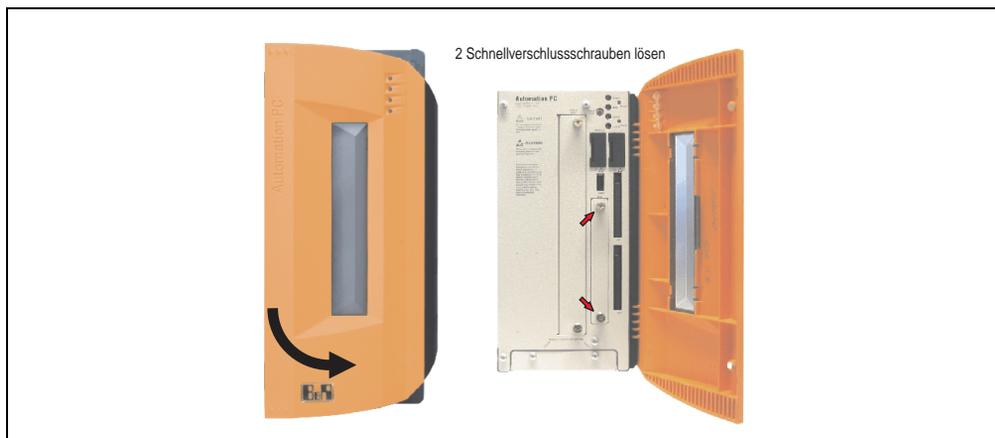
Abbildung 125: Schnellverschlusschrauben lösen
