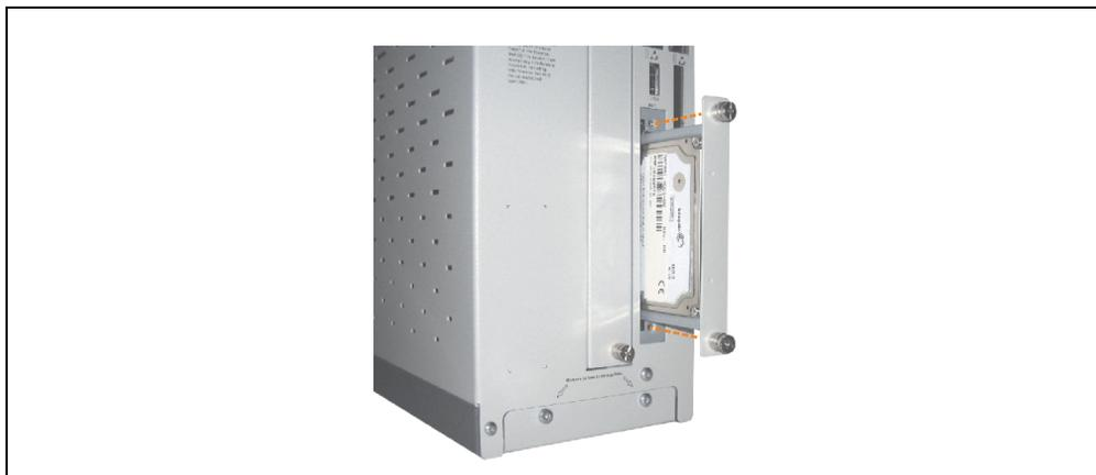
Abbildung 126: Compact SATA Laufwerk einschieben
