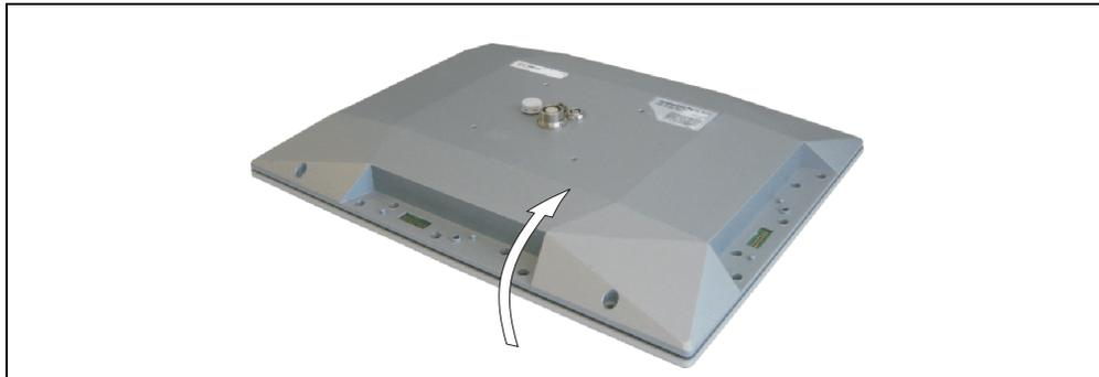
Abbildung 118: Gehäuse öffnen
