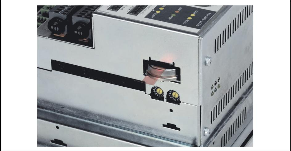
Abbildung 104: Power Panel 41 - Batteriewechsel
