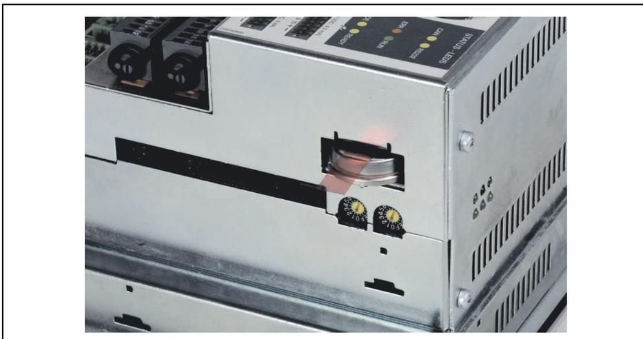
Abbildung 52: Power Panel 21 - Batteriewechsel
