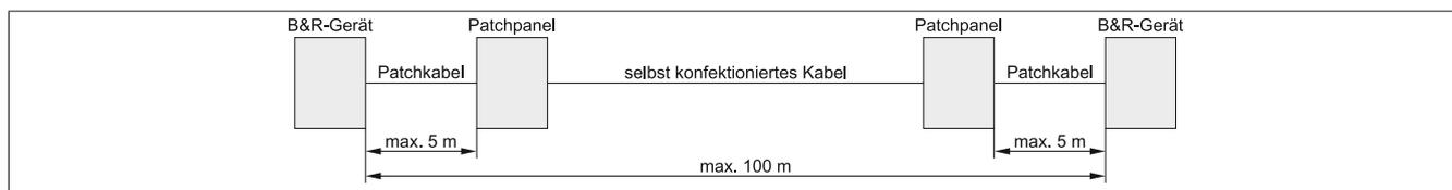
Abbildung 136: Verkabelung mit selbst konfektioniertem Kabel
