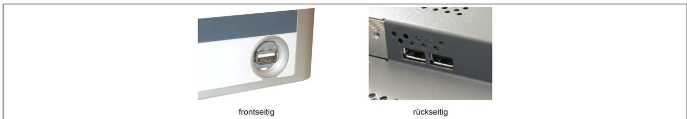
Abbildung 2: Automation Panel USB Anschlüsse (frontseitig - rückseitig)
