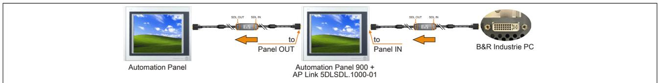
Abbildung 132: Beispiel für die Signalrichtung Display - Display für das SDL Kabel flex mit Extender
