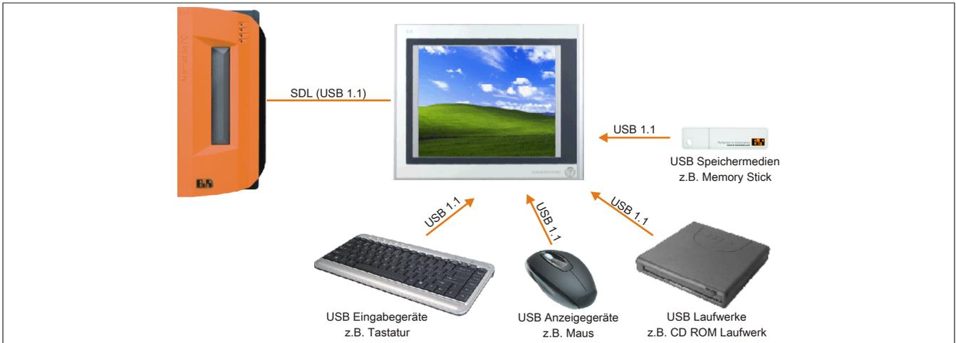
Abbildung 101: Anschluss von USB Peripheriegeräten remote am AP800/900 über SDL
