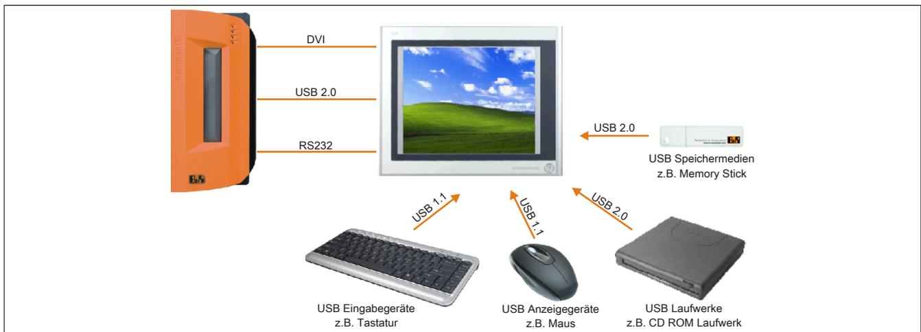
Abbildung 100: Anschluss von USB Peripheriegeräten remote am AP900 über DVI
