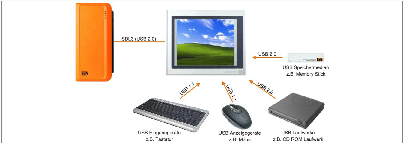
Abbildung 102: Anschluss von USB Peripheriegeräten remote am 900 über SDL3
