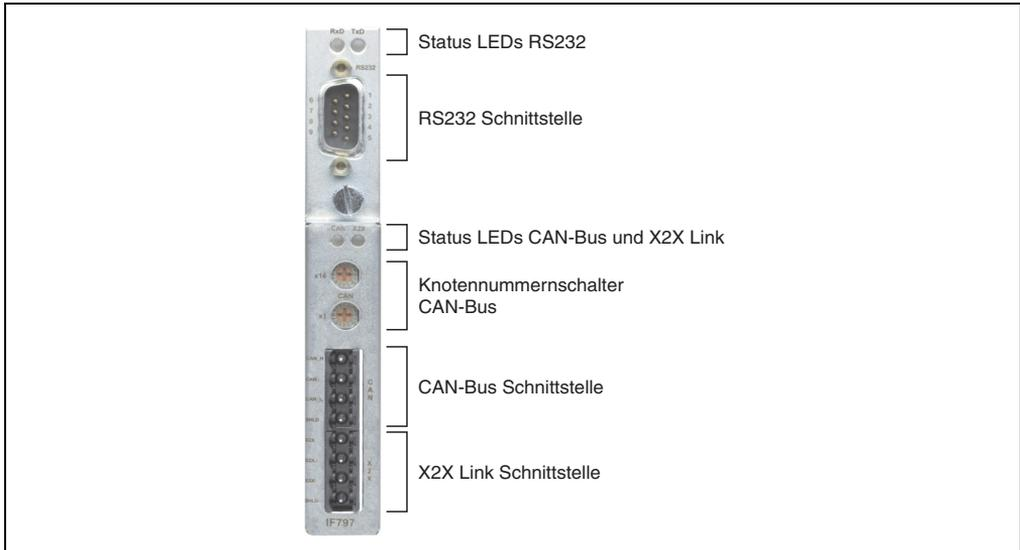
Abbildung 1: IF797 Bedien- und Anschlusselemente
