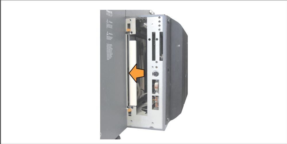
Abbildung 364: Slide-in Blindmodulentfernung
