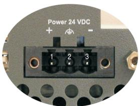
Abbildung 29: Spannungsversorgungsanschluss
