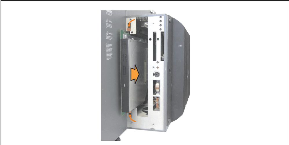
Abbildung 368: Slide-in Laufwerkseinbau
