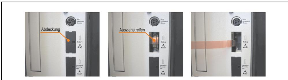
Abbildung 350: Batterie herausziehen
