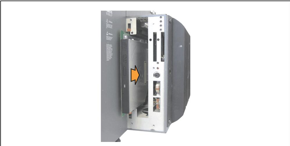
Abbildung 365: Slide-in Laufwerkseinbau
