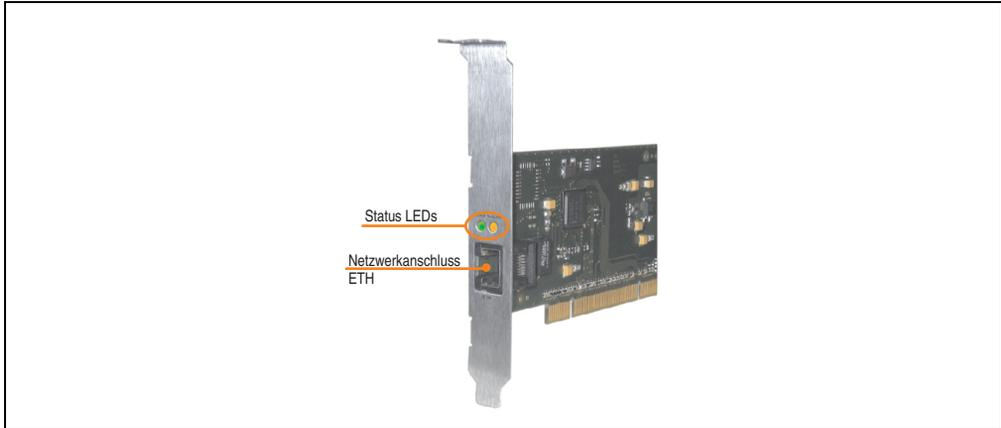
Abbildung 346: PCI Ethernet Card 10/100 - 5ACPCI.ETH1-01
