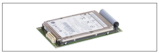
Figure 85: Add-on hard disk 20 GB ET - 5AC600.HDDI-01
