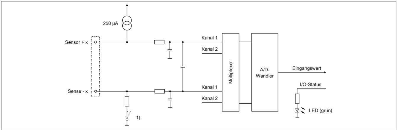
1) Schalter ist bei 2-Leiteranschluss geschlossen
