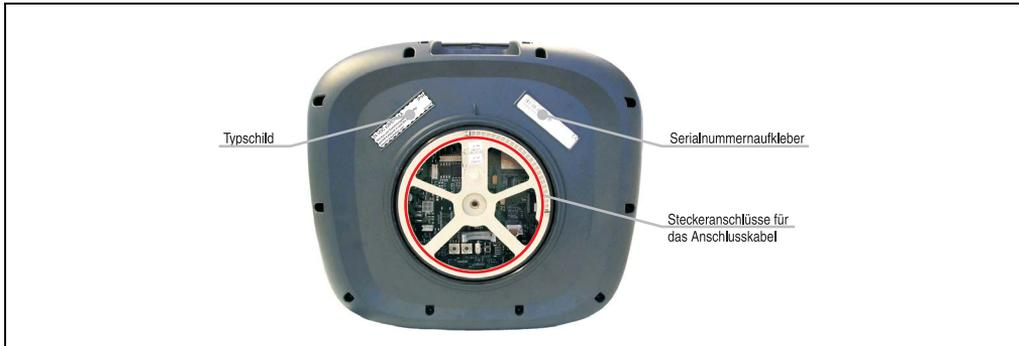
Abbildung 12: Bedienteil - Rückseite
