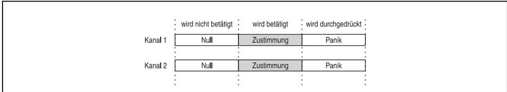
Abbildung 25: Mögliche Zustimmungstasterpositionen
