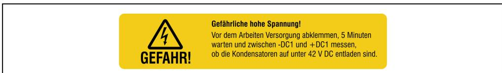
Abbildung 3: Warnschild am Servoverstärker
