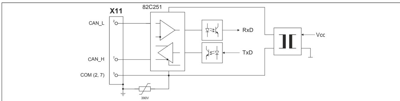
Abbildung 1: Ein-/Ausgangsschema AC110
