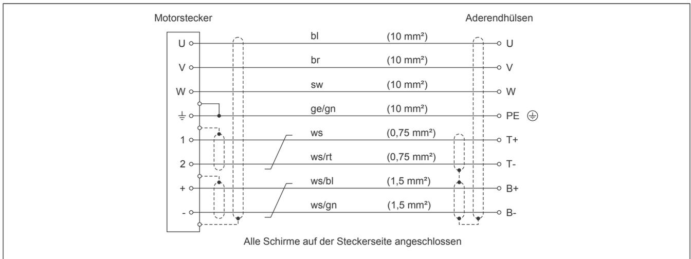
Abbildung 1: Kabelplan Motorkabel 10 mm<sup>2</sup>
