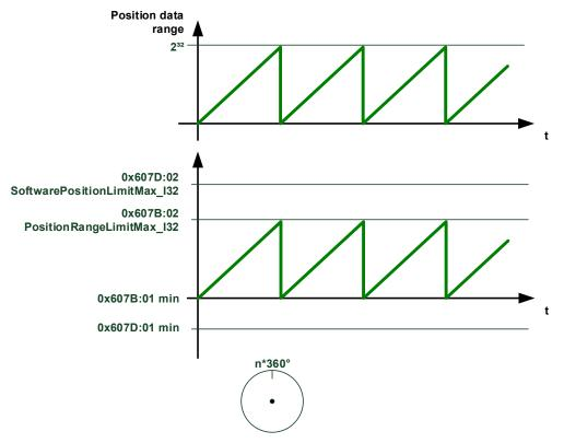
Figure 37: Position actual value in modulo format
