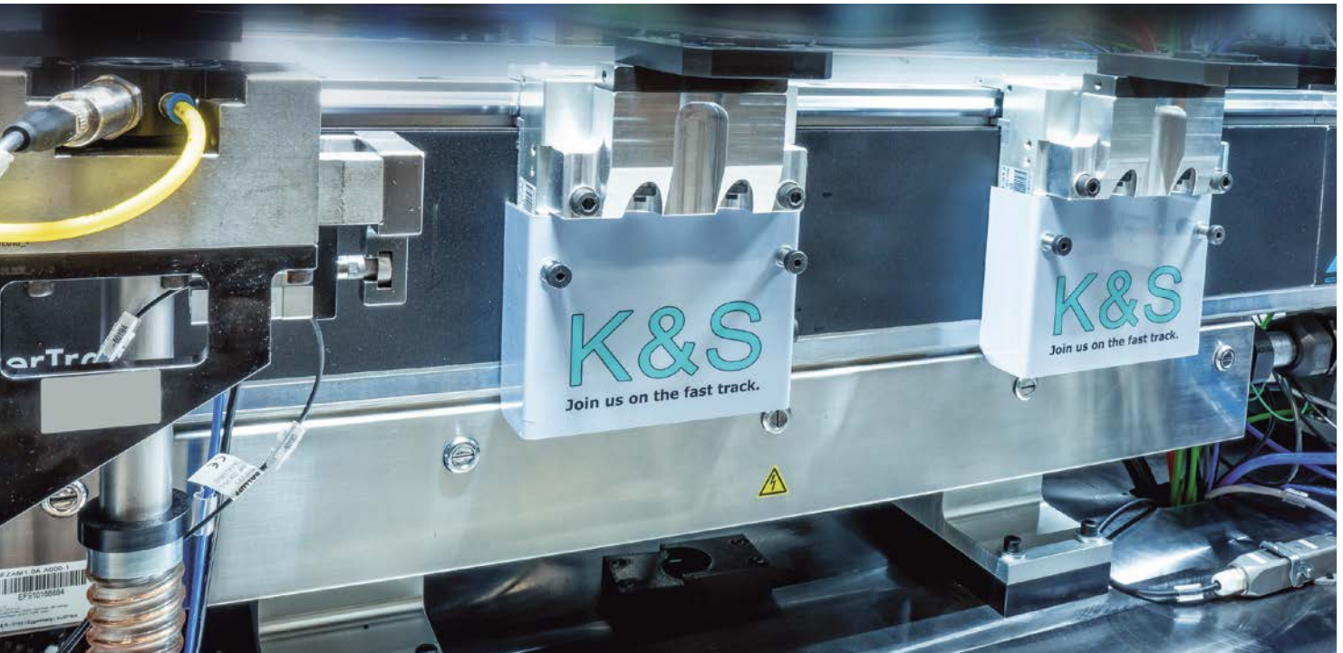
Die individuell steuerbaren Shuttles mit dem Werkstückträger sind die Grundlage für die hohe Flexibilität der Montageanlage.
