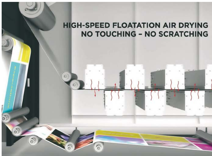
Bei der Trocknung entstehen brennbare Dämpfe. Sie werden beim ProStream mit der integrierten Sicherheitstechnik von B&R überwacht.
