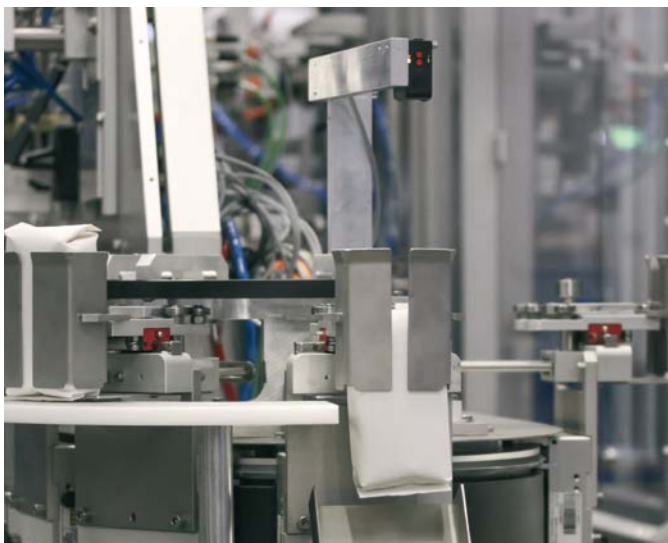
Durch die frei programmierbaren Verfahrenprofile von SuperTrak kann der Anlagenbauer Stationen frei anordnen oder Stationen zusätzlich anfahren oder überspringen.
