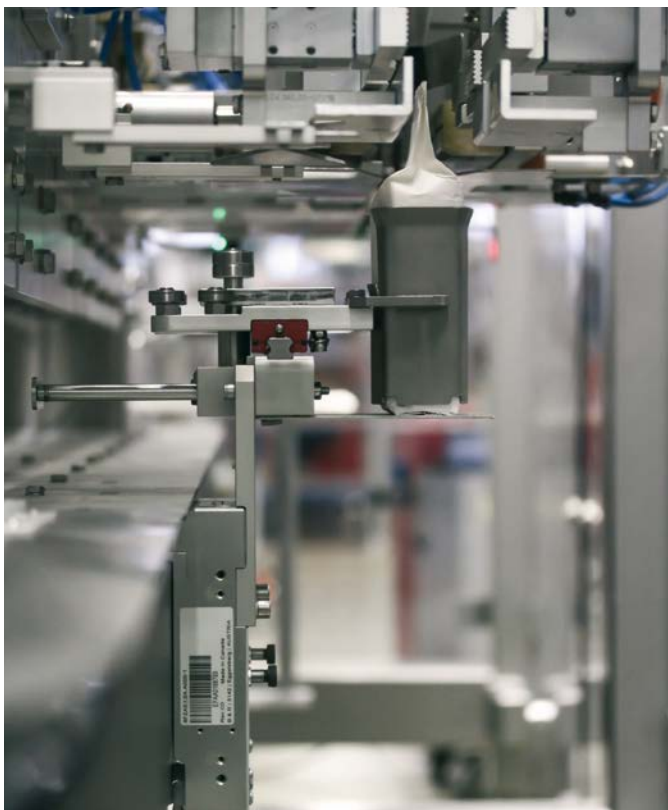
Das Transportsystem der Kopfverschließmaschine fährt die einzelnen Beutel zu den verschiedenen Prozessstationen.
