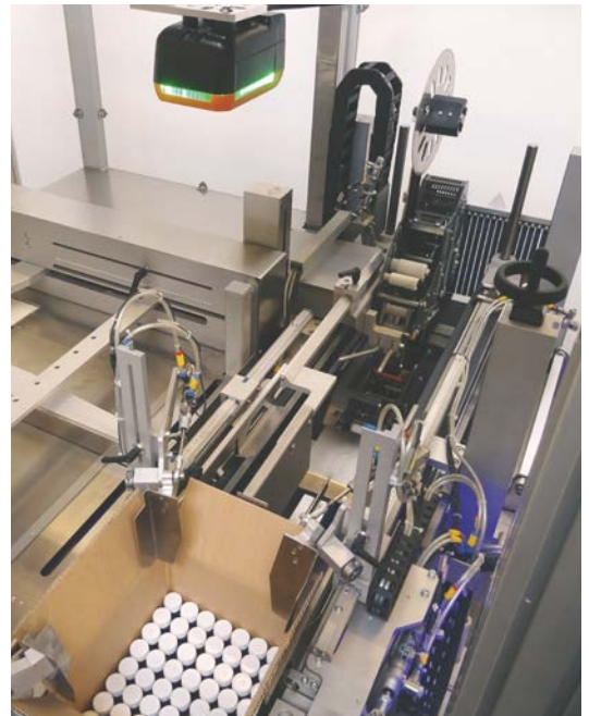
2020 stellt Christ die erste CaseTeq mit integriertem Vision-System von B&R vor. Das System ist flexibler als ein Lichtgitter und einfach in der Handhabung.
