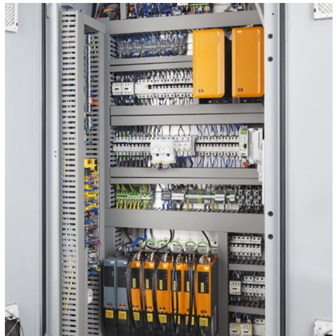
Die Synchronisation und sicherheitsgerichtete Kommunikation zwischen mehr als 20 Achsen an der Maschine erfolgt über openSAFETY über POWERLINK.
