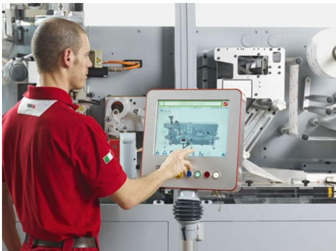
Die Bedienoberfläche ist ein Automation Panel, das IMA in sein eigenes HMI-Housing-System integriert hat.
