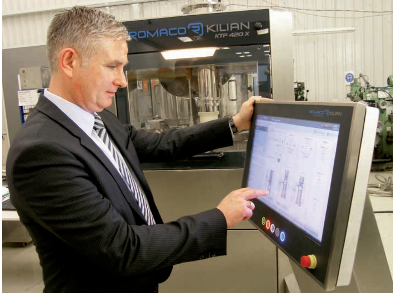
Das neu konzipierte Visualisierungssystem mit Gestensteuerung basiert auf einem leistungsfähigen Industrie-PC vom Typ Automation PC 910 mit Dual-Core-i7-Prozessor und einem hygienegerechten Automation Panel mit 21,5-Zoll-Display.
