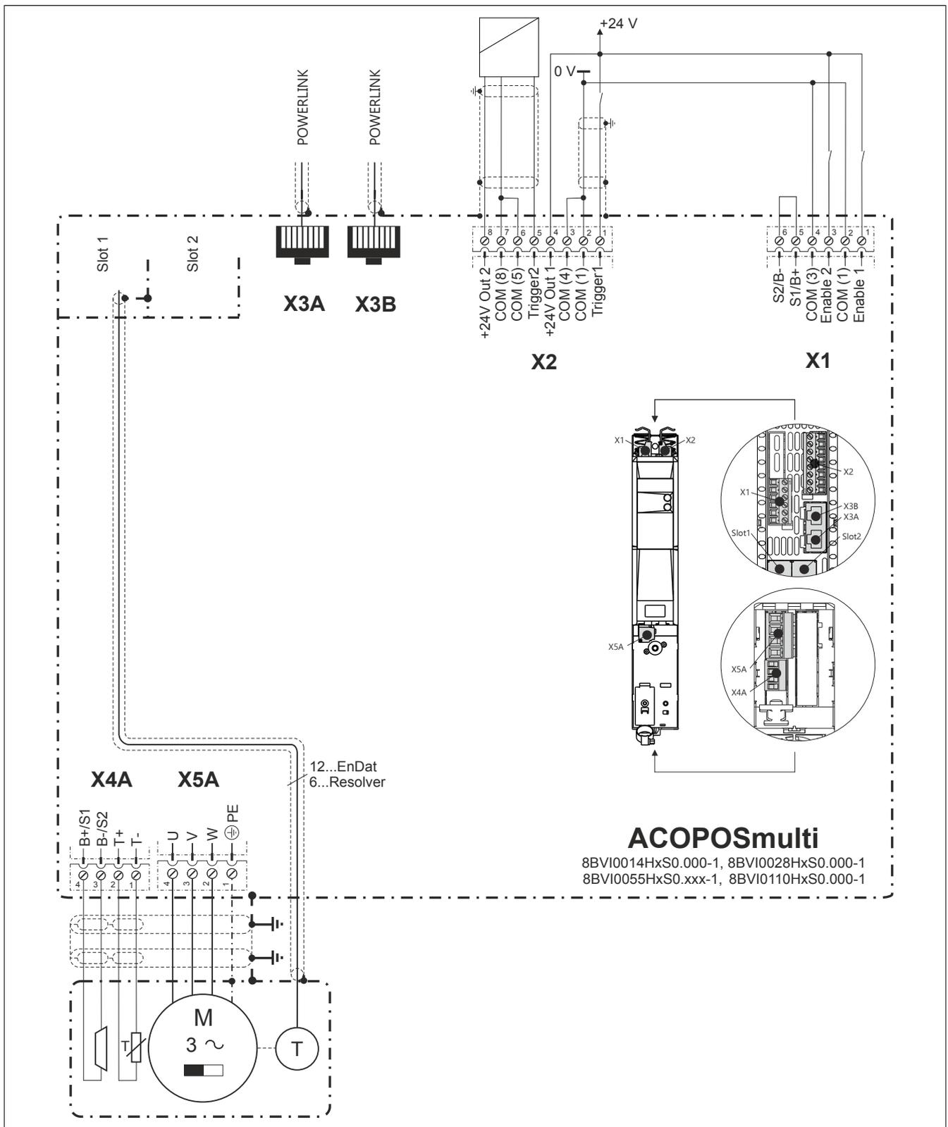
Abbildung 5: Übersicht Anschlussbelegungen 8BVI0014HxS0.000-1, 8BVI0028HxS0.000-1, 8BVI0055HxS0.xxx-1, 8BVI0110HxS0.000-1
