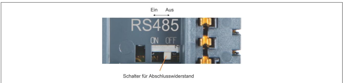
Auf der Busbasis ist bereits ein Abschlusswiderstand für die RS485-Schnittstelle integriert. Mit einem Schalter wird der Abschlusswiderstand zu- oder abgeschaltet. Ein aktivierter Abschlusswiderstand wird am Einspeisemodul durch die LED "T" angezeigt.
