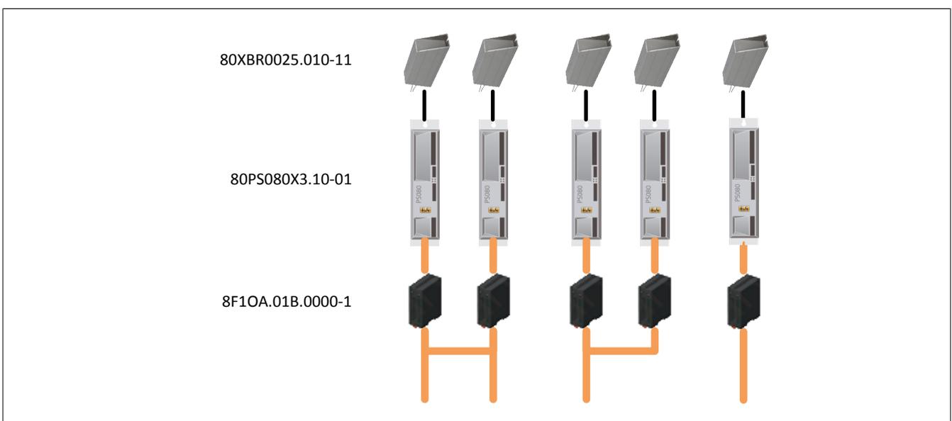
Abbildung 109: Beispiel Leistungsversorgung für ACOPOStrak Transportsysteme
