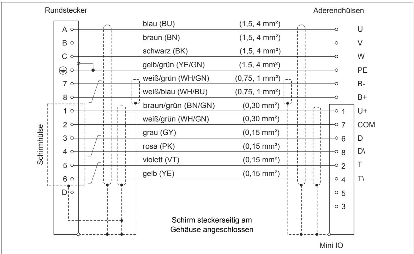
Abbildung 1: Kabelplan Motorhybridkabel
