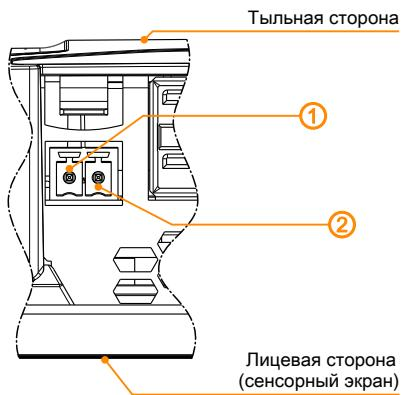
Описание выводов для подключения источника питания приведено в таблице ниже, а также указано на задней панели устройства Power Panel. Панели Power Panel имеют защиту от обратной полярности, которая исключает повреждение устройства вследствие некорректного подключения источника питания.
