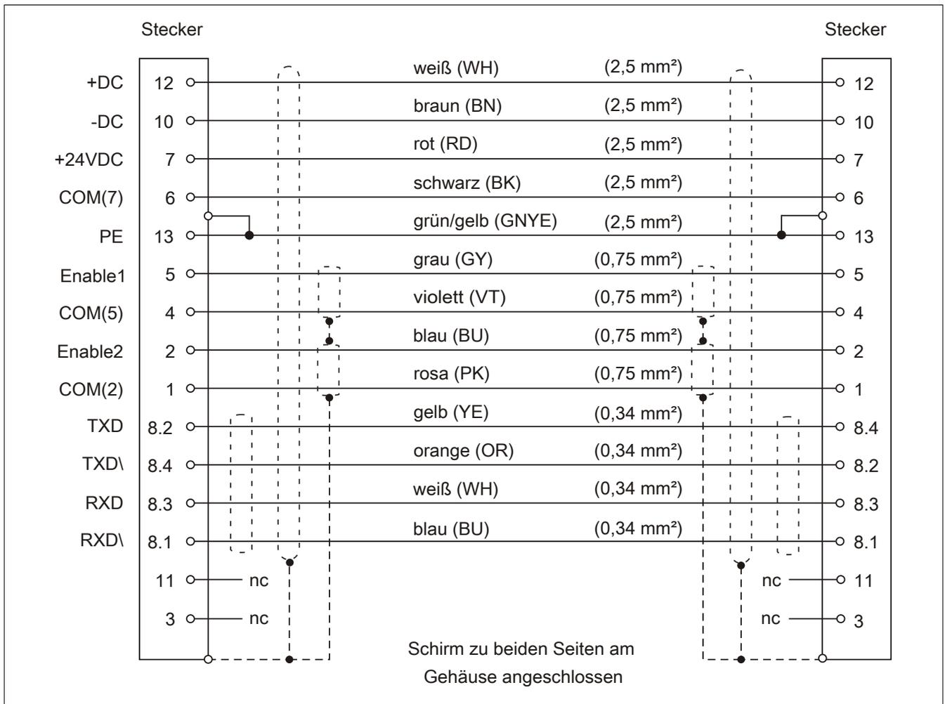
Abbildung 1: Kabelplan Hybridkabel
