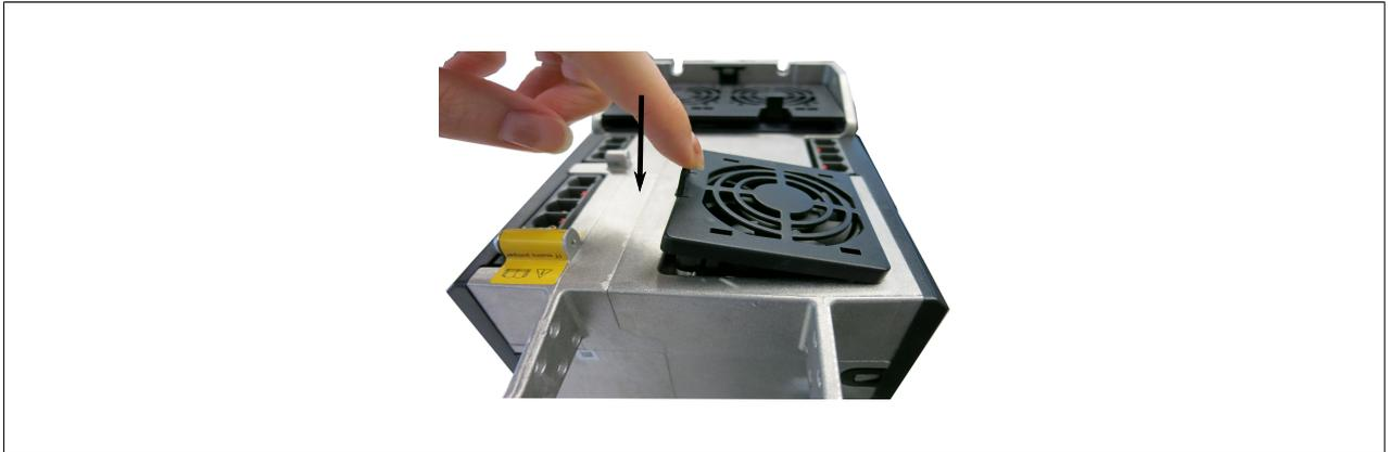
Abbildung 3: Lüftermodul einbauen
