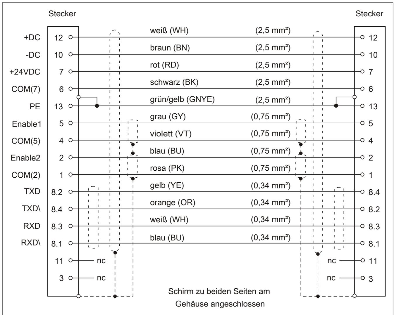
Abbildung 1: Kabelplan Hybridkabel 8CCHxxxx.11340-1
