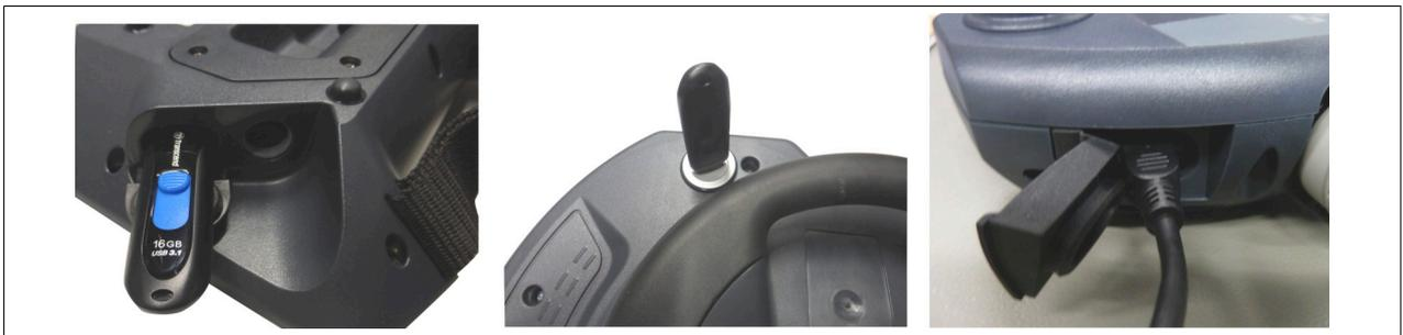
Abbildung 38: USB-Schnittstelle - USB Device anstecken
