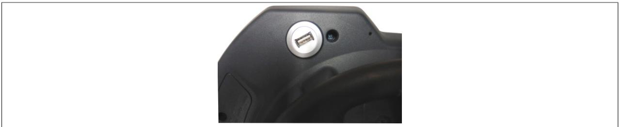
Abbildung 37: USB-Schnittstelle - Schnittstelle frei zugänglich
