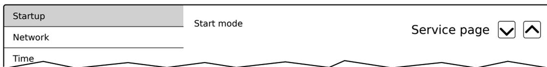
Auf der Serviceseite *Startup* wird der Startmodus konfiguriert, wie sich das Mobile Panel nach dem Einschalten verhält. Abhängig von dieser Einstellung wird das Mobile Panel mit einem der folgenden Modi (*Start mode*) gestartet:
