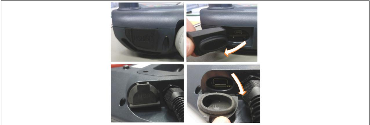
Abbildung 36: USB-Schnittstelle - Schutzklappe öffnen
