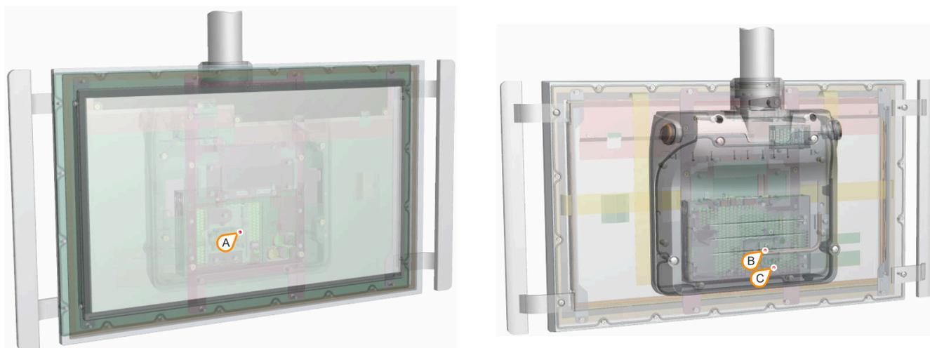
Рисунок 3: Положение температурных датчиков
