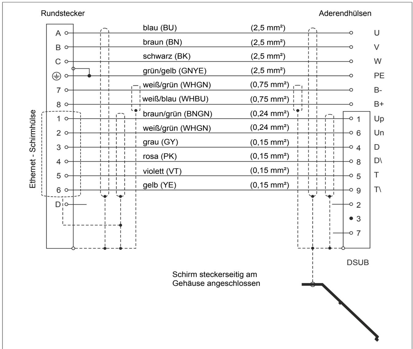
Abbildung 1: Kabelplan Motorhybridkabel 2,5 mm<sup>2</sup> FoodGrade
