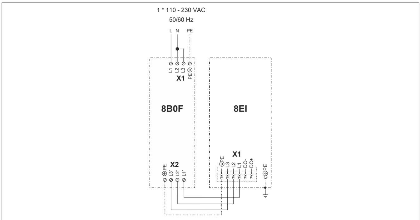
Abbildung 5: Netzanschluss 1x 110 - 230 VAC
