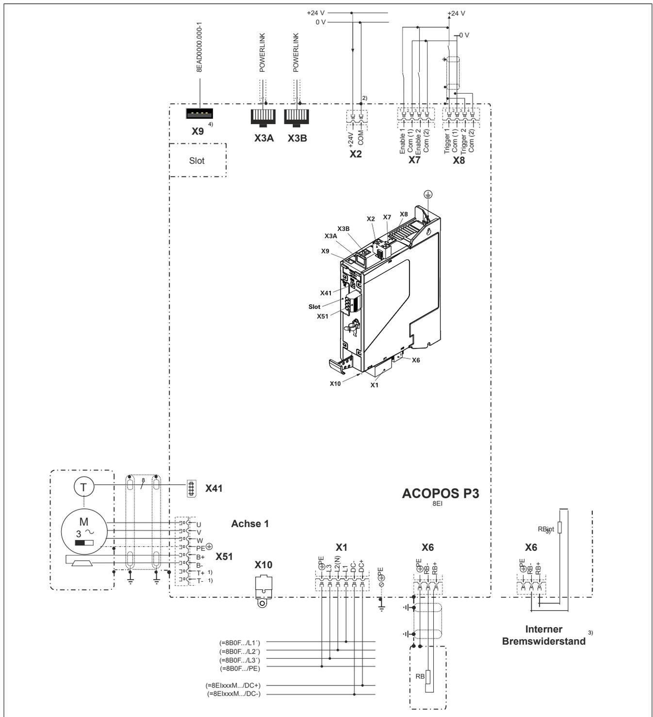
Abbildung 4: Netzeingangsspannung 1x 110 bis 230 VAC / 3x 200 bis 230 VAC
