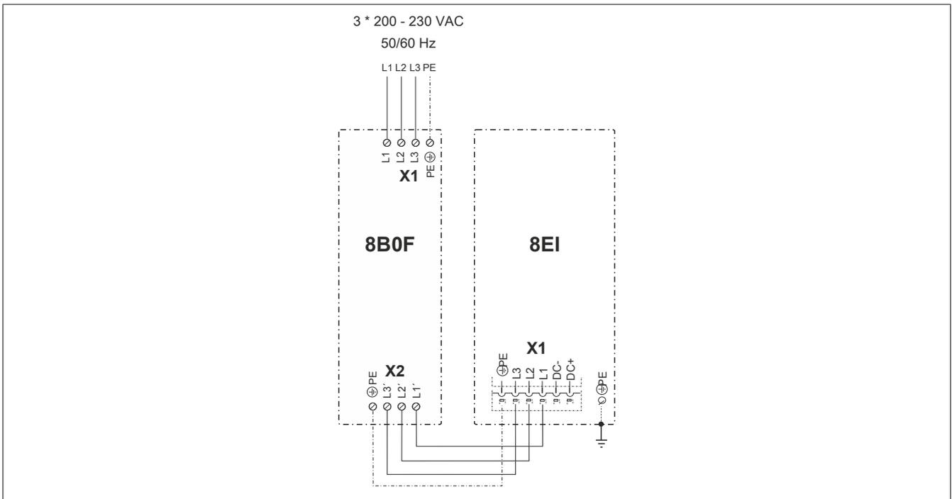
Abbildung 6: Netzanschluss 3x 200 - 230 VAC
