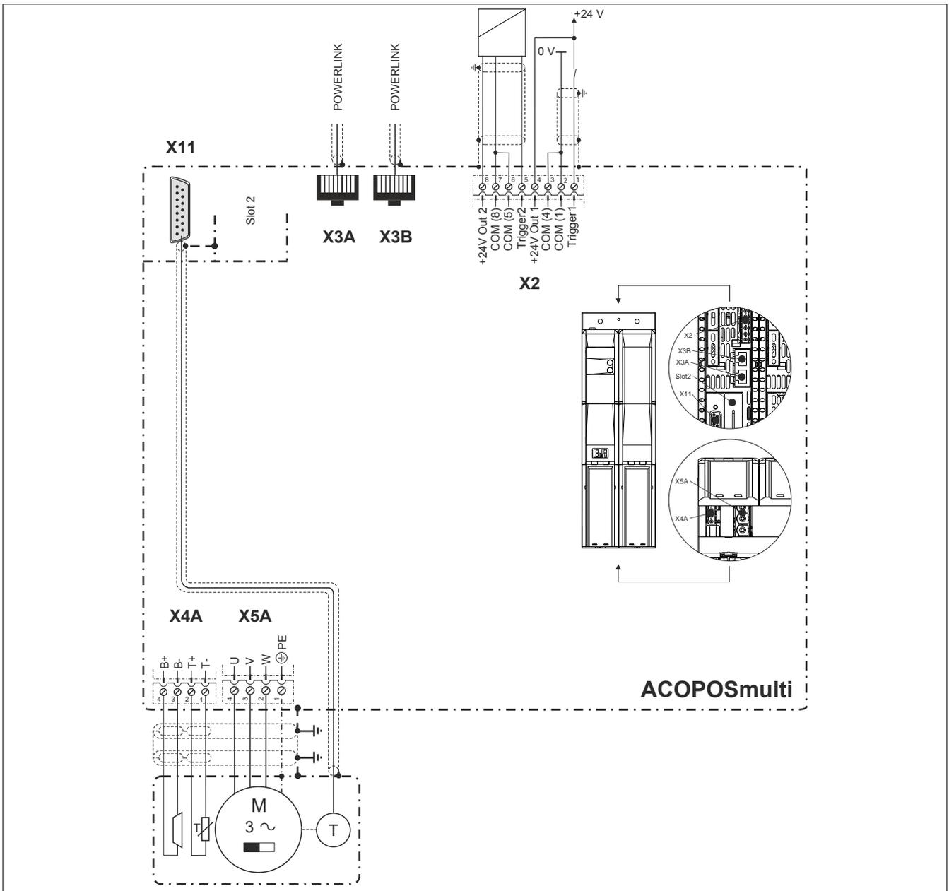
Abbildung 3: Übersicht Anschlussbelegungen
