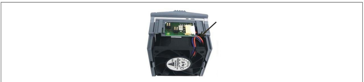
4. Das neue Lüftermodul soweit in die Montageplatte einschieben, bis die beiden Rasthaken hörbar einrasten.
