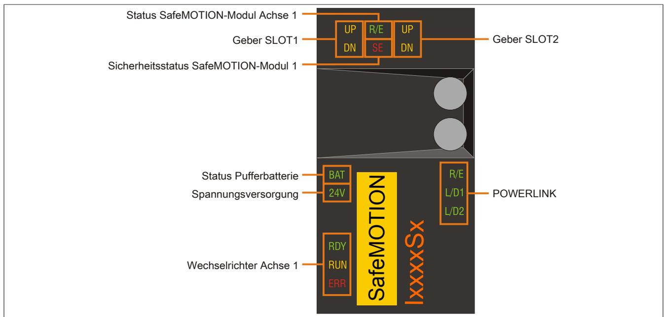
Abbildung 1: Anzeigengruppen SafeMOTION Wechselrichtermodule 8BVI (Einachsmodule)<sup>1)</sup>
