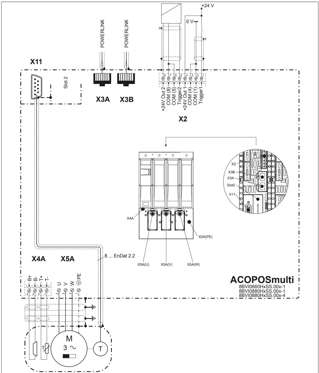
Abbildung 6: Übersicht Anschlussbelegungen
