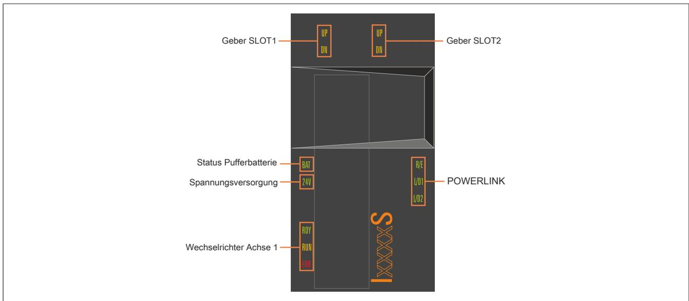
Abbildung 3: Anzeigengruppen Wechselrichtermodule 8BVI (Einachsmodule)
