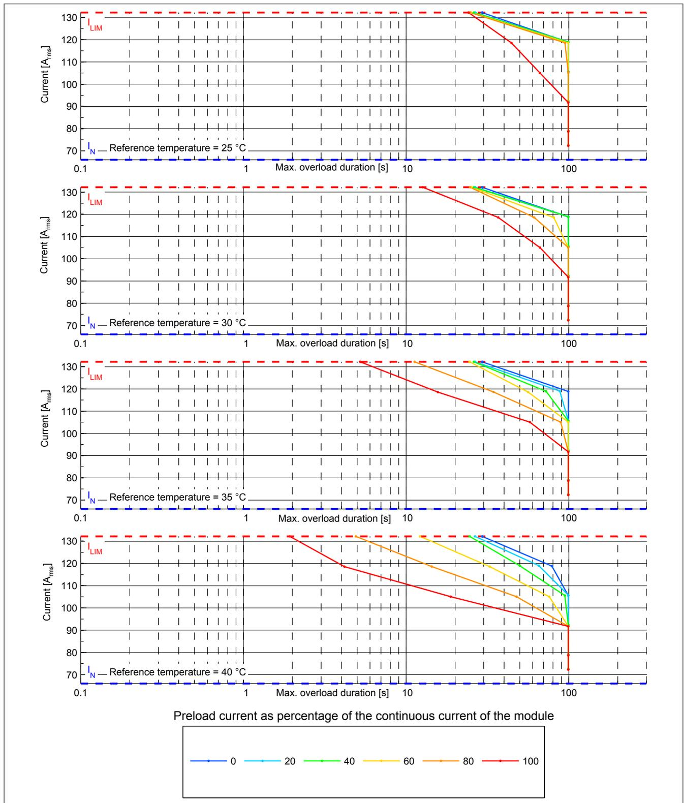
Abbildung 2: Überlast-Charakteristik 8BVI0660HWSx.000-1, Überlastreaktion - ERROR + STOP
