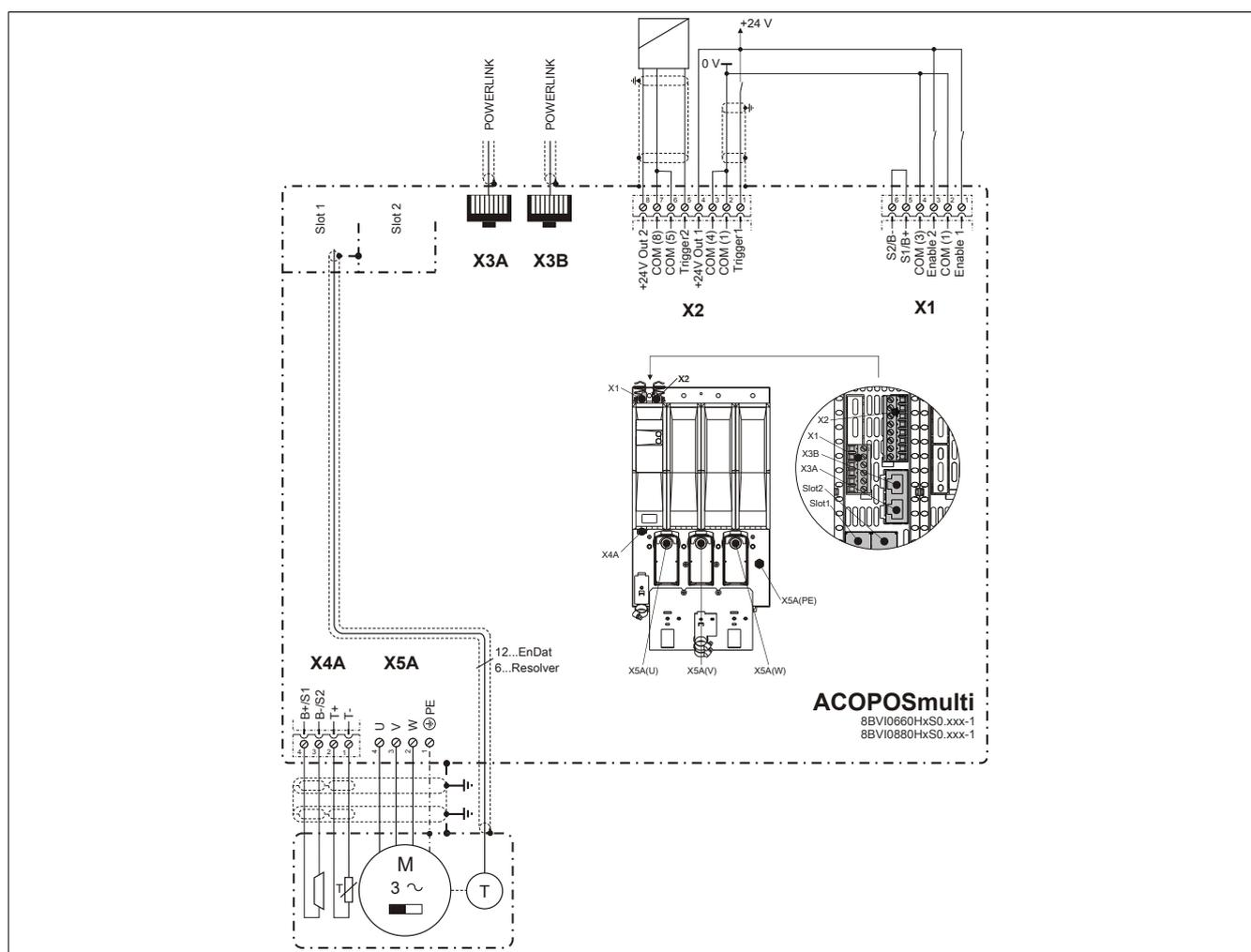
Abbildung 5: Übersicht Anschlussbelegungen
