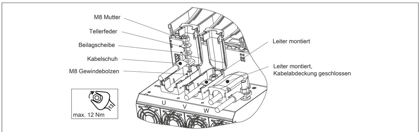
Abbildung 6: Kabelmontage Motoranschlüsse U, V, W
