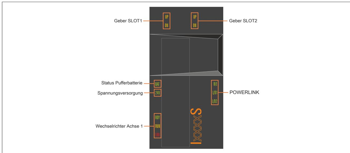
Abbildung 3: Anzeigengruppen Wechselrichtermodule 8BVI (Einachsmodul)<sup>1)</sup>
