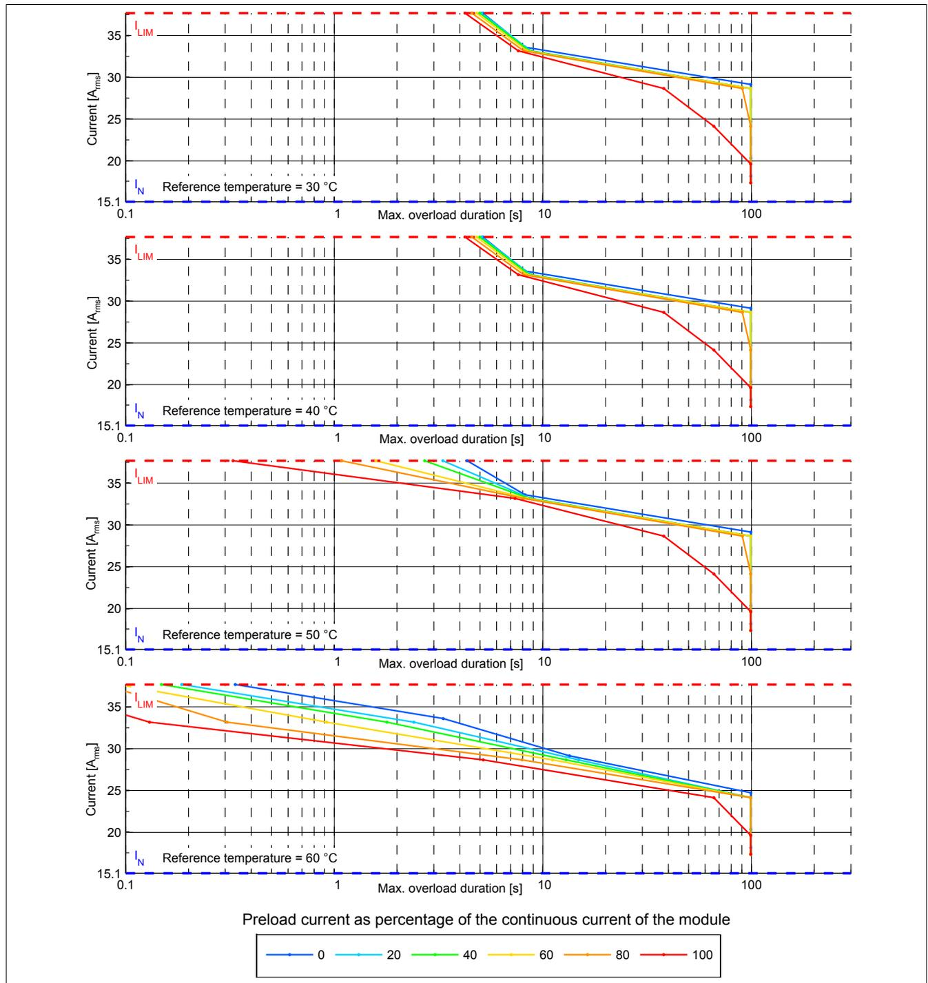
Abbildung 1: Überlast-Charakteristik 8BVI0110HCSx.000-x, Überlastreaktion - WARNING
