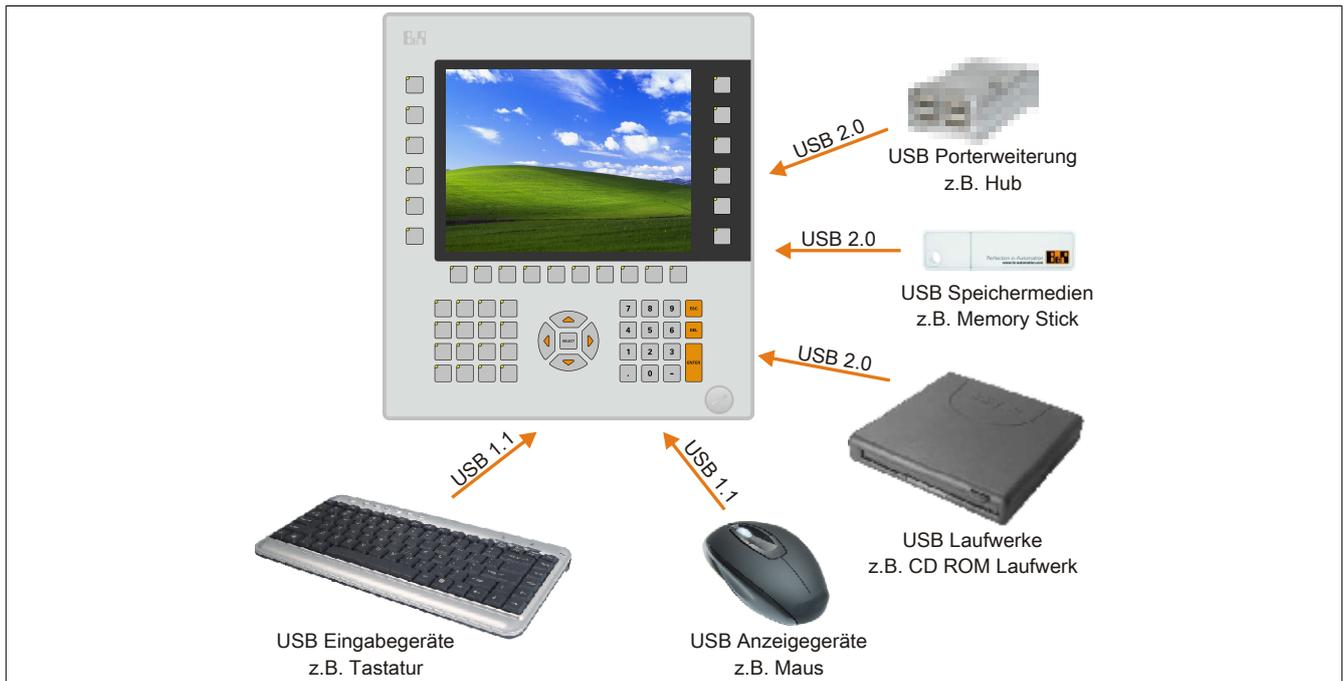
Abbildung 72: Anschluss von USB Peripheriegeräten lokal am PP500
