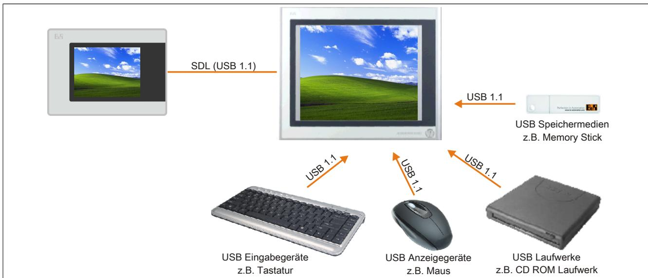
Abbildung 74: Anschluss von USB Peripheriegeräten remote am AP800/900 über SDL
