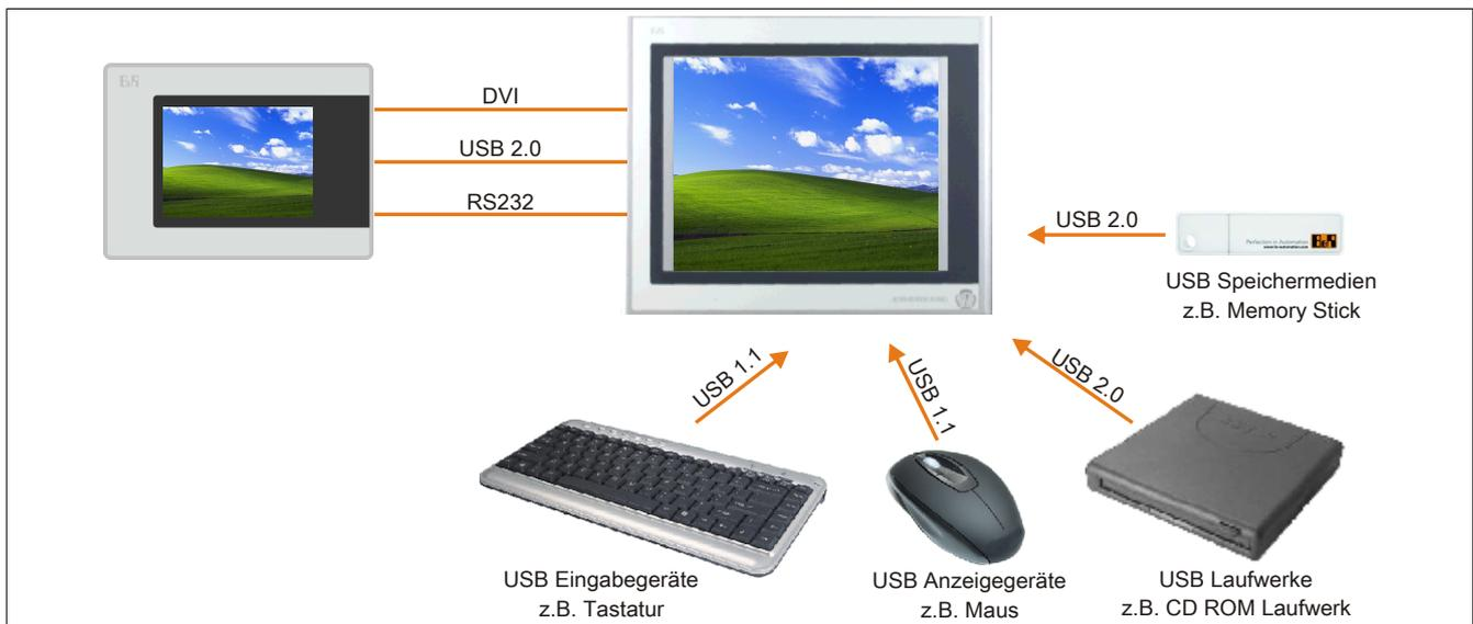
Abbildung 73: Anschluss von USB Peripheriegeräten remote am AP900 über DVI
